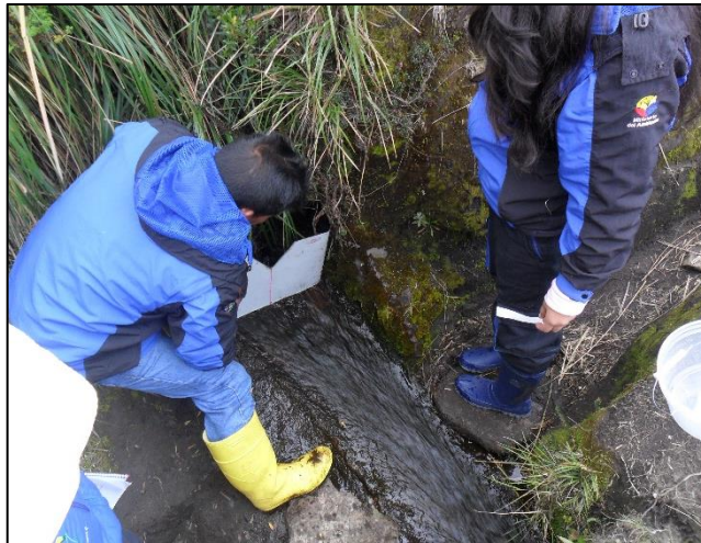
Figura 7. Medición de caudal por el método de vertedero triangular
