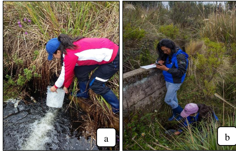
Figura 30. Medición de caudal por método volumétrico. a) Recoger el agua en un balde de 5 litros, b) Registro de tiempo en la ficha de campo
