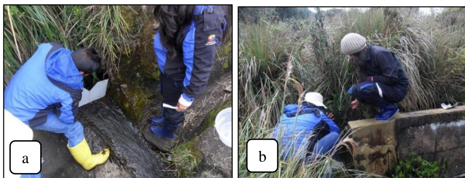
Figura 34. Medición de caudal método de vertedero. a) Vertedero triangular, b) Vertedero rectangular
