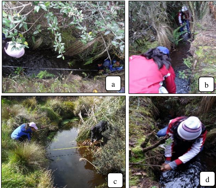
Figura 31. Medición de caudal método de flotador. a y b ) Búsqueda de sección recta y medición longitudinal del canal, c) Medición ancho del canal, d) Medición de profundidades
