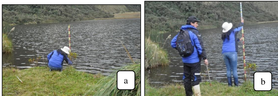
Figura 37. Lectura del limnómetro y maxímetro. a) Obtención de dato limnimétrico, b) Obtención de dato maximétrico
