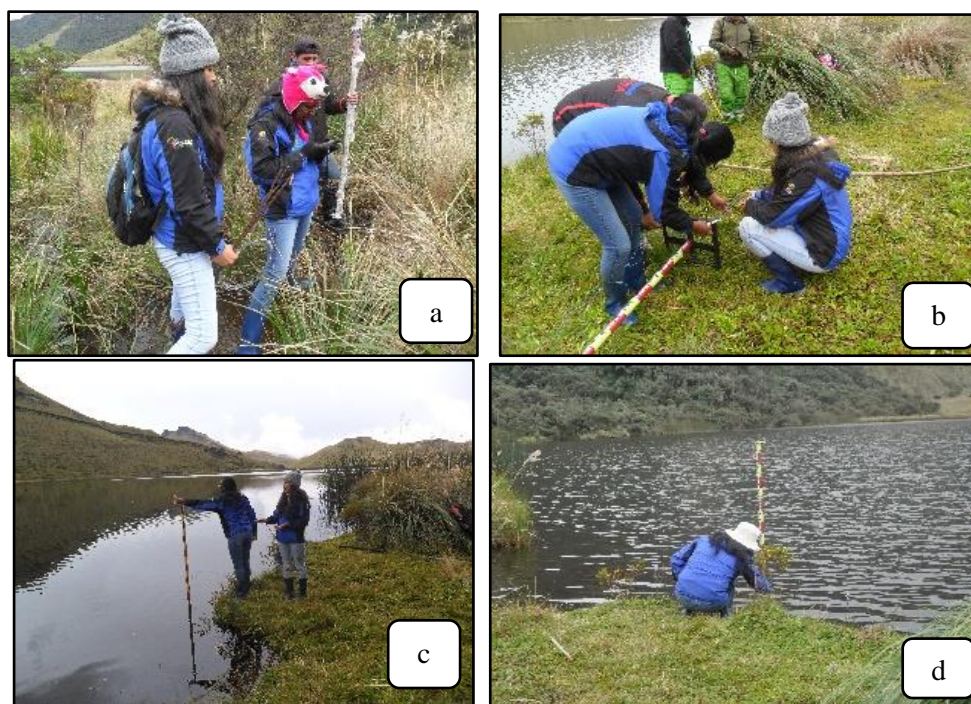
Figura 4. a) Ubicación de coordenadas, b) y c) Preparación y Establecimiento del limnómetro, d) Lectura de datos
