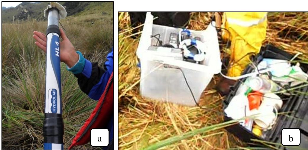
Figura 39. Equipos utilizados en campo. a) Hidrolab HL4, b) Equipos para batimetría
