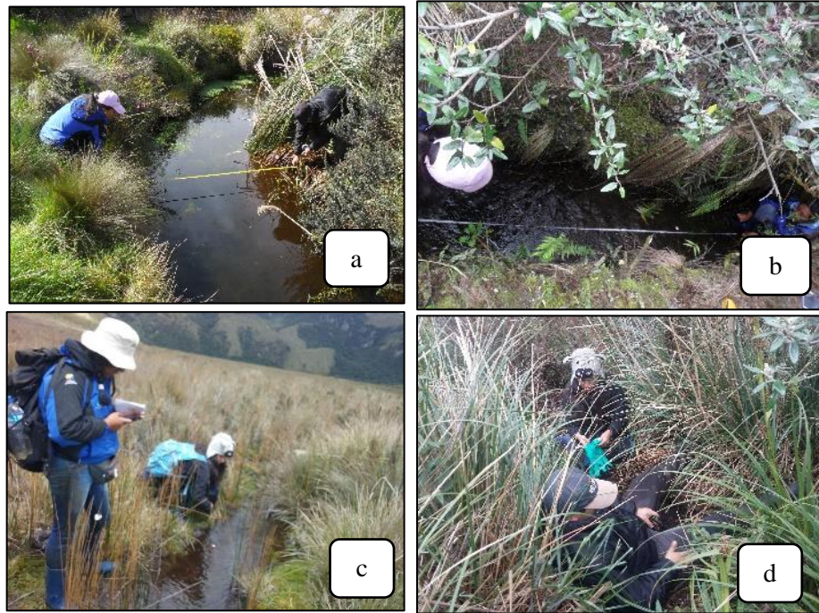
Figura 6. Medición de caudales por el método de flotador, a) Ancho de sección, b) Distancia de sección, c) Registro del tiempo del recorrido del flotador, d) Profundidad media
