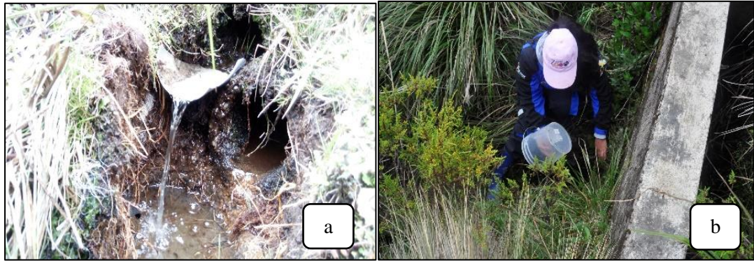
Figura 5. Medición de caudales por el método volumétrico, a) Ubicación caudal pequeño, b) Medición de caudal
