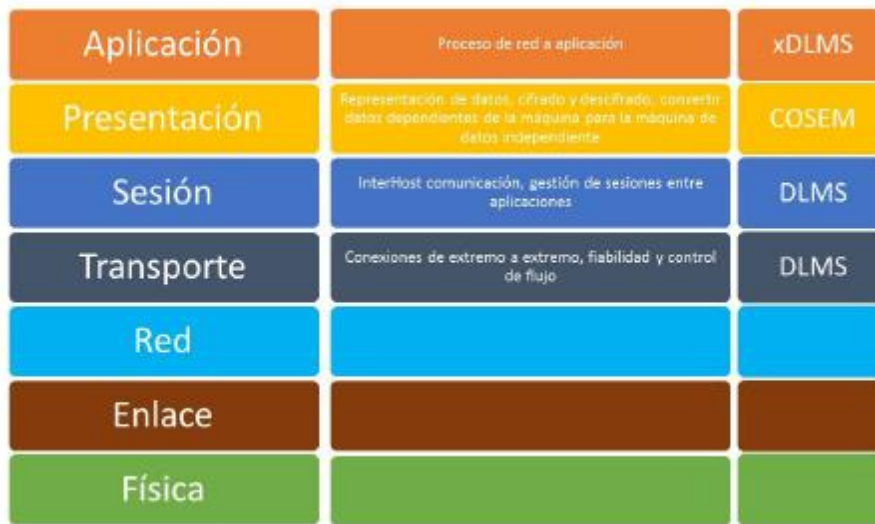
Figura 3. Modelo de capas de DLMS/COSEM Fuente: (CERTSI, 2017)
