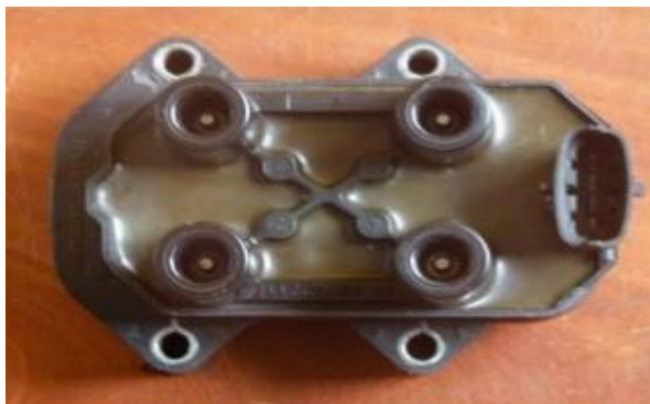
Figura1. 27: Bobina de encendido (Andrade, 2014)
