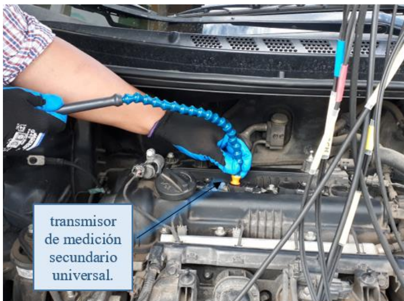
Figura3. 39: Conexión del equipo
