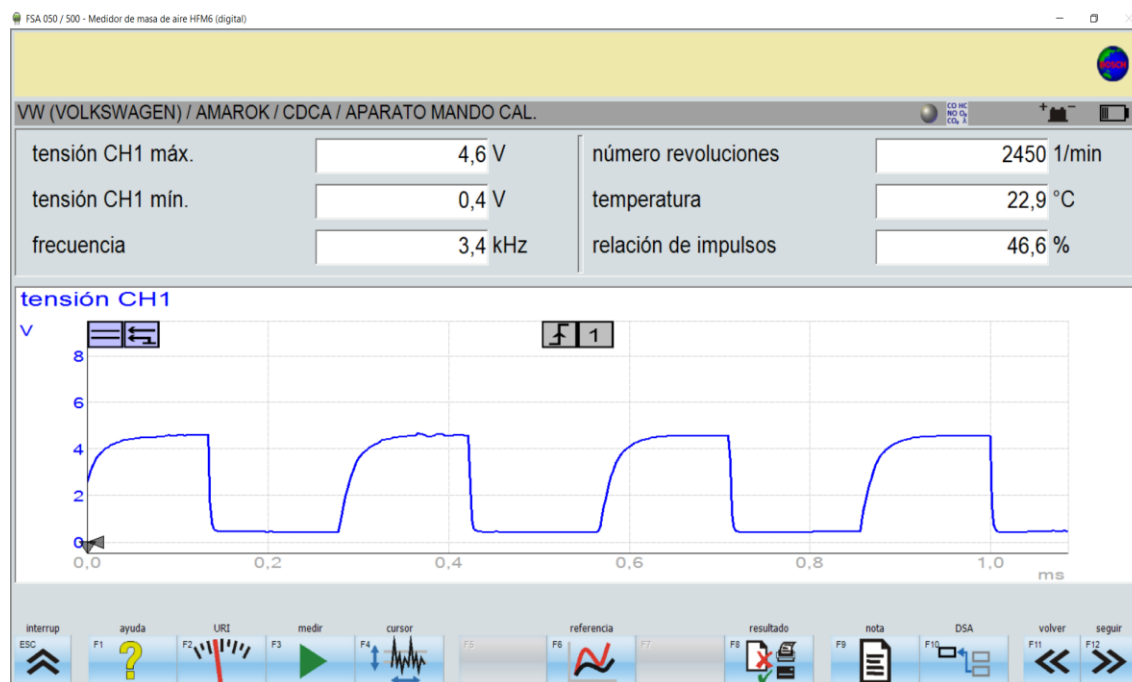
Figura3. 19: Señal del sensor de masa de aire HFM6 (digital) con el motor acelerado
