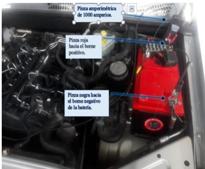
Figura3. 7: Conexión del equipo
