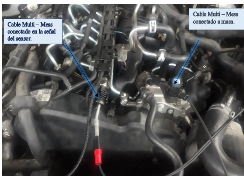
Figura3. 13: Conexión del equipo
