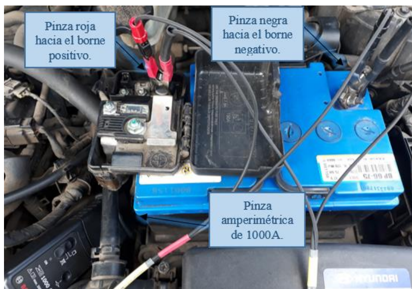
Figura3. 27: Conexión del equipo
