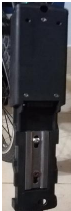
Figura 25. Placa de sujeción de la batería. Fuente. Autor.
