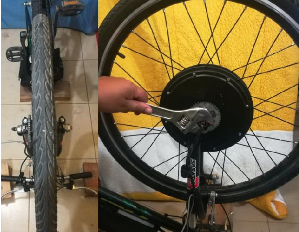
Figura 24. Montaje de la rueda en la bicicleta. Fuente. Autor.
