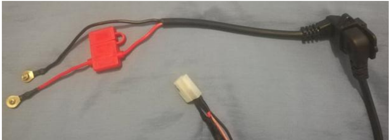
Figura 18. Cable de conexión de la batería al controlador. Fuente. Autor.
