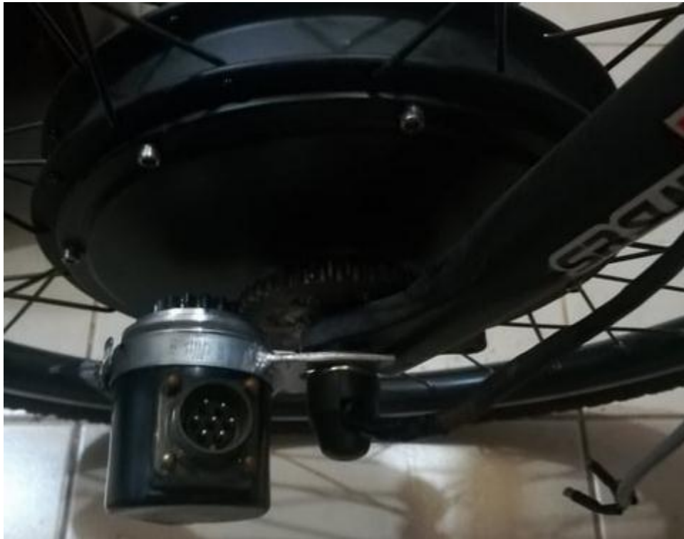
Figura 29. Montaje del codificador óptico incremental. Fuente. Autor.
