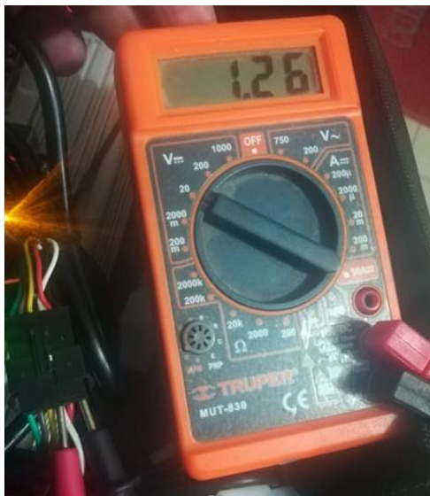
Figura 31. Medición inicial de la señal del acelerador eléctrico. Fuente. Autor.
