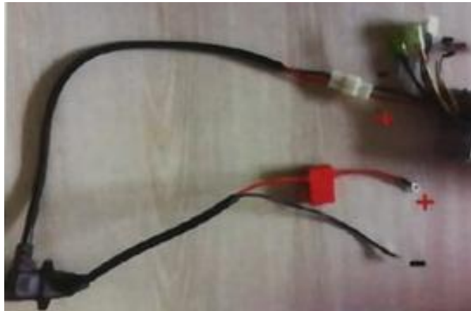
Figura 4. Conector desde el controlador hasta la batería. Fuente. Autor
