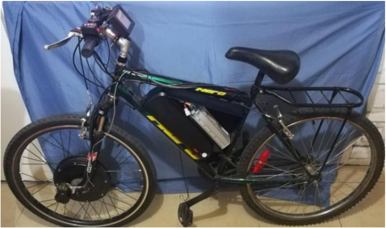
Figura 6. Bicicleta montado los componentes eléctricos. Fuente. Autor
