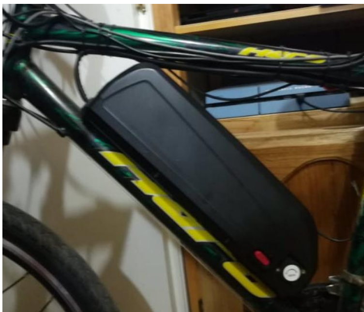
Figura 26. Montaje de la batería. Fuente. Autor.
