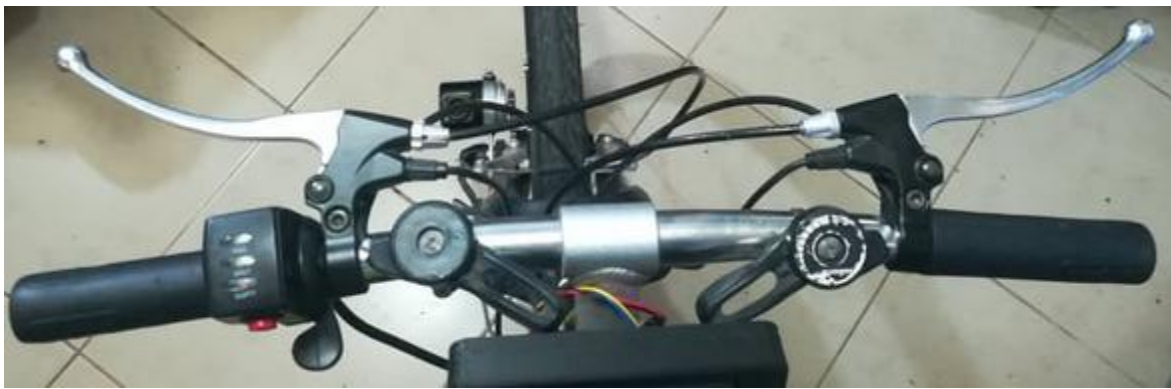
Figura 27. Montaje del acelerador eléctrico y frenos eléctricos. Fuente. Autor.
