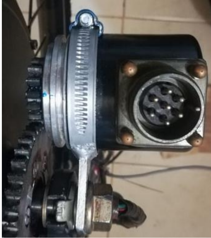
Figura 33. Codificador óptico incremental TK610. Fuente. Autor.
