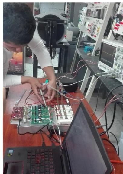
**Figura 74.** Prueba de generación de pulsos en vacío
