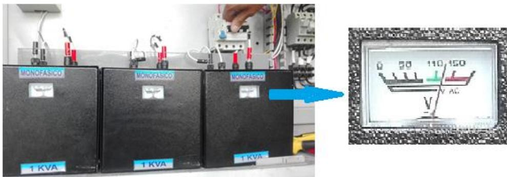
Figura 56. Pruebas de funcionamiento de banco de transformadores.
