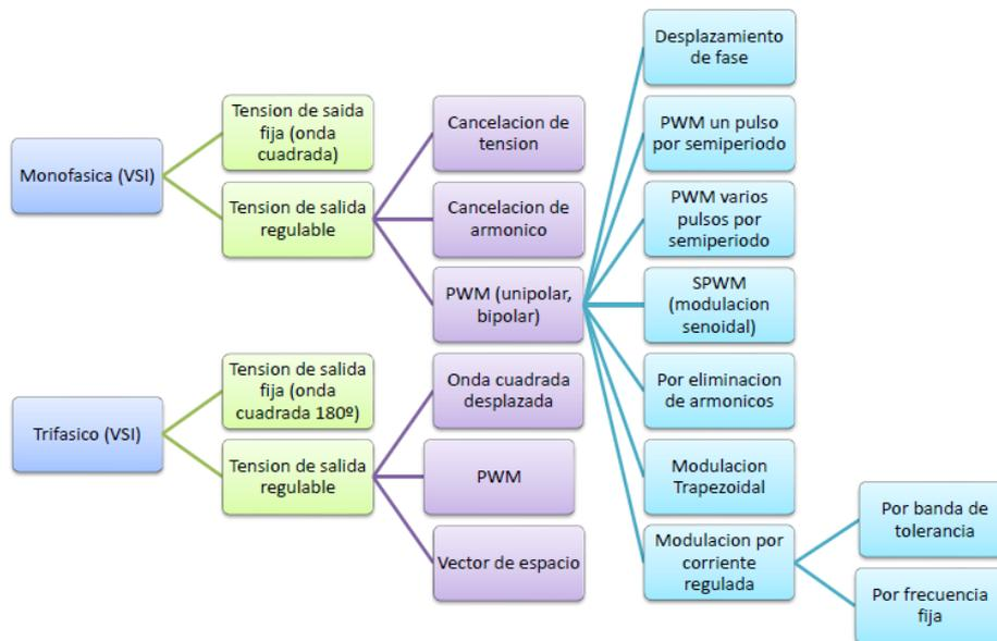
Figura 7. inversores alimentados con fuente de voltaje
