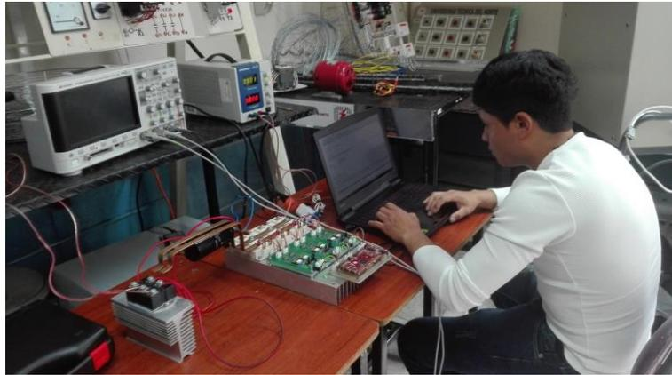
**Figura 47. Pruebas de funcionamiento de modulo inversor trifásico**
