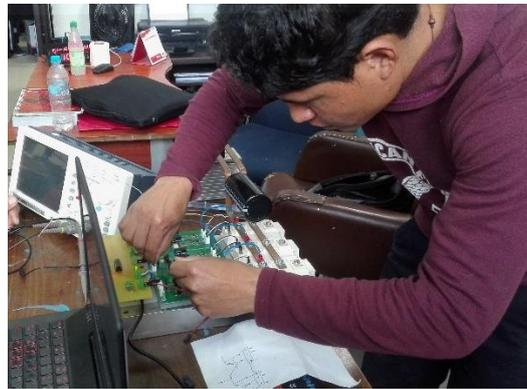
**Figura 73.** Montaje de elementos en placa de accionamientos de IGBT
