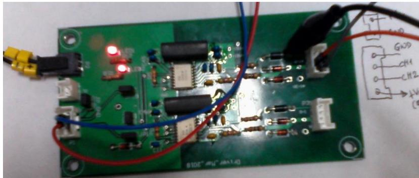
Figura 11. Descripción general de placa de accionamiento de GBT
