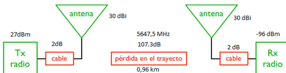
Figura 3.31: Ganancias y Pérdidas del Sistema Enlace Backhaul Nodo GADMU – Nodo LSE
