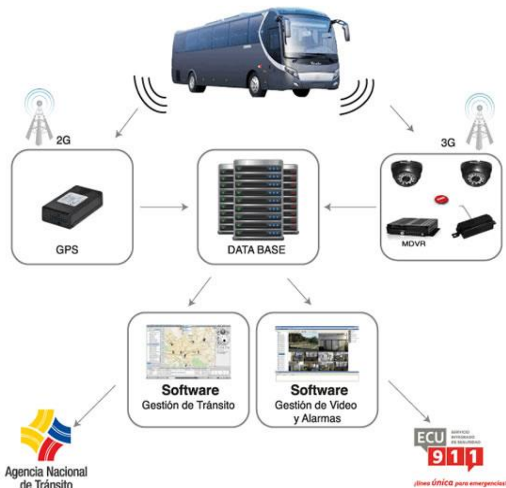
Figura 1.2 Funcionamiento del rastreo satelital- Ecuador
