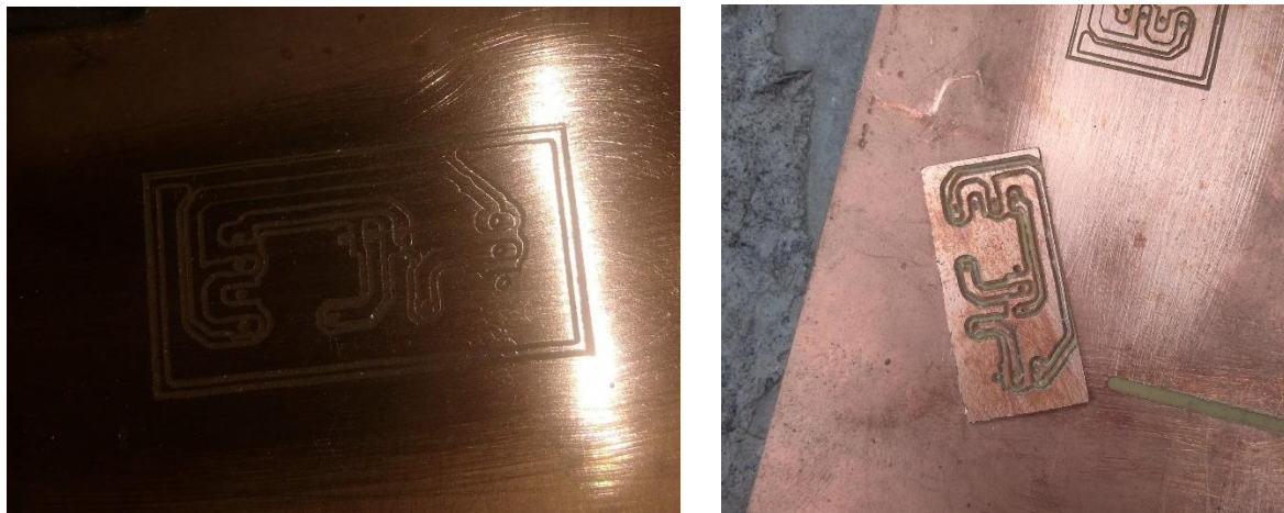
Figura 53. Grabado, perforación y corte
