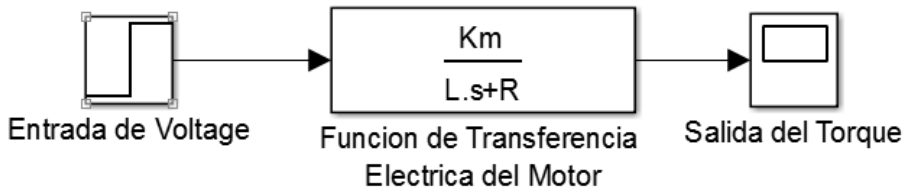
Figura 35. Diagrama de Bloques Torque del Motor DC Simulink-Matlab
