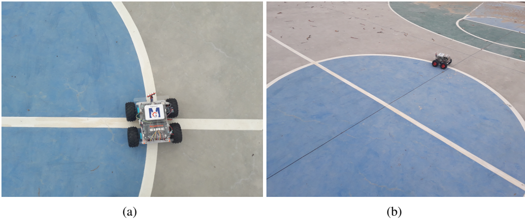
Figura 6.26: Prueba de trayectoria circular lazo cerrado, a) punto inicial, b) recorrido del robot móvil
