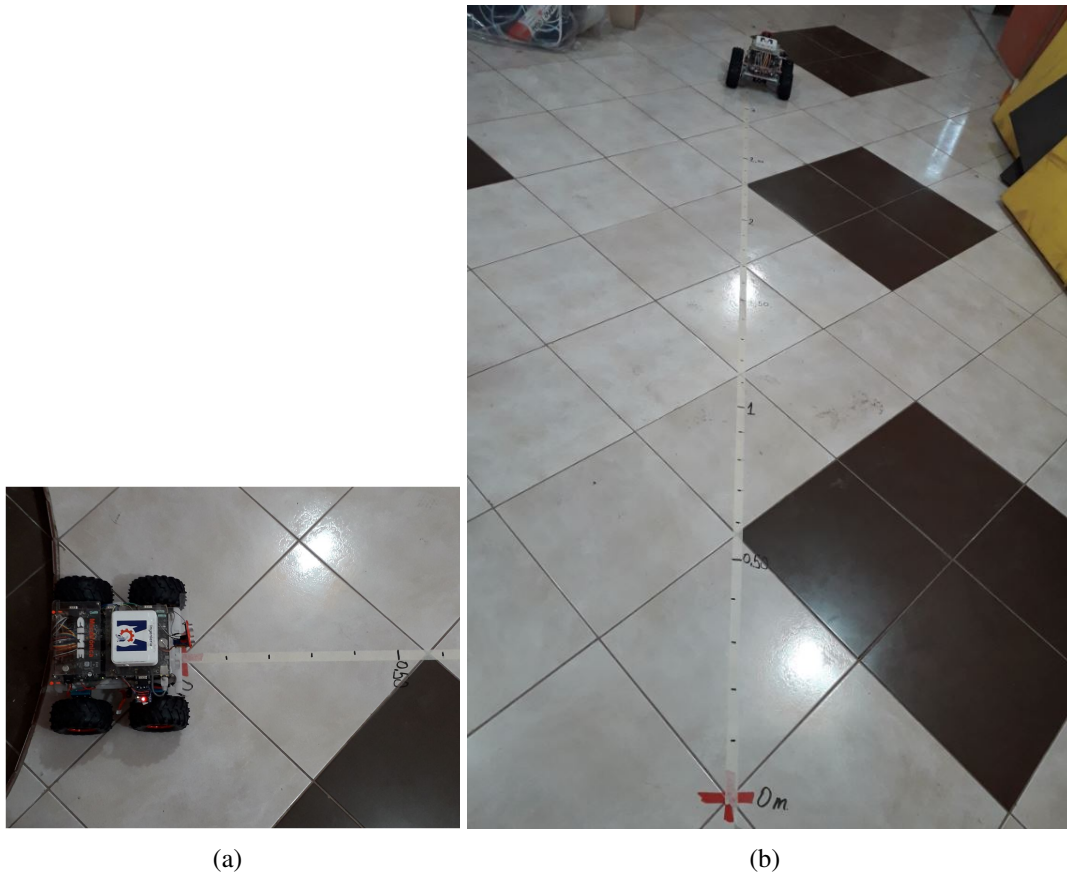
Figura 6.18: Prueba real trayectoria rectilínea superficie lisa, a) punto de partida, b) punto final
