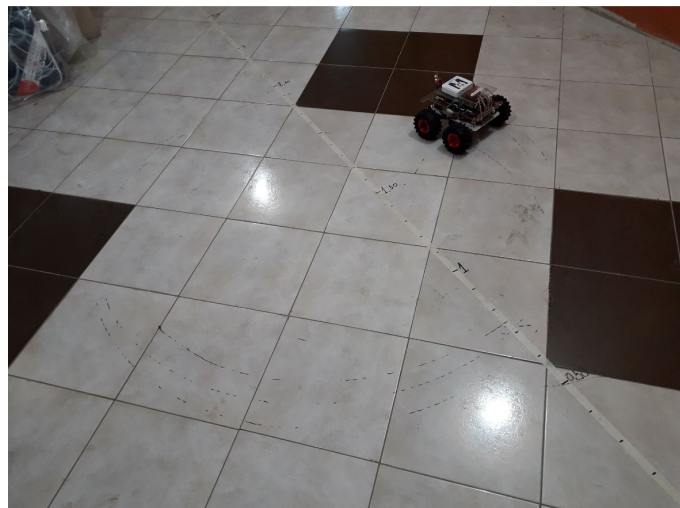
Figura 6.20: Prueba real trayectoria circular superficie lisa
