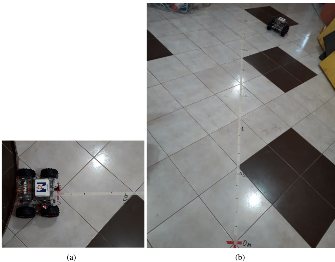
Figura 6.16: Prueba real trayectoria rectilínea superficie lisa a) punto de partida, b) punto final
