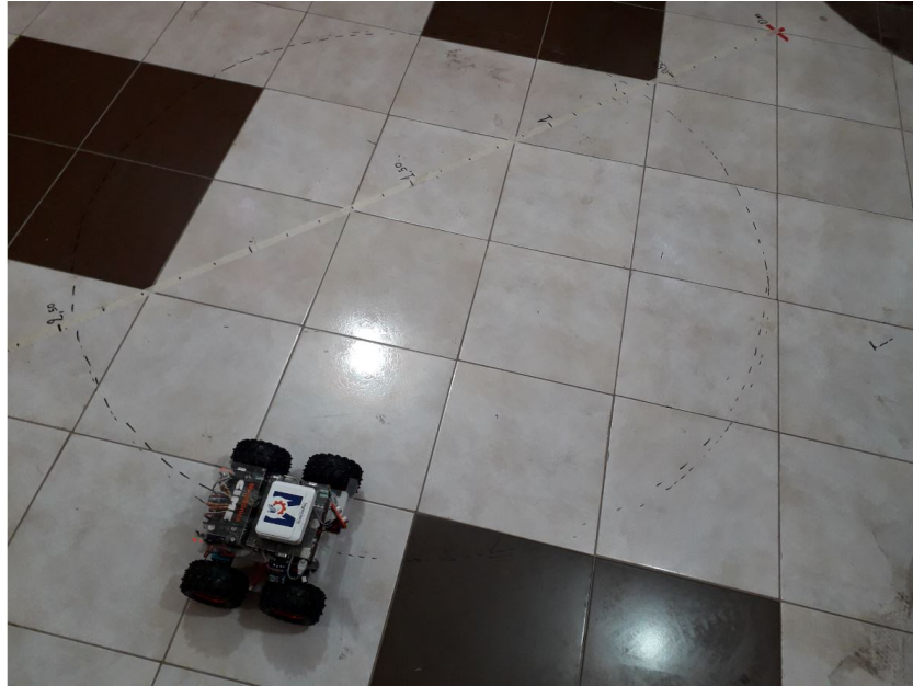
Figura 6.22: Prueba real trayectoria circular superficie lisa
