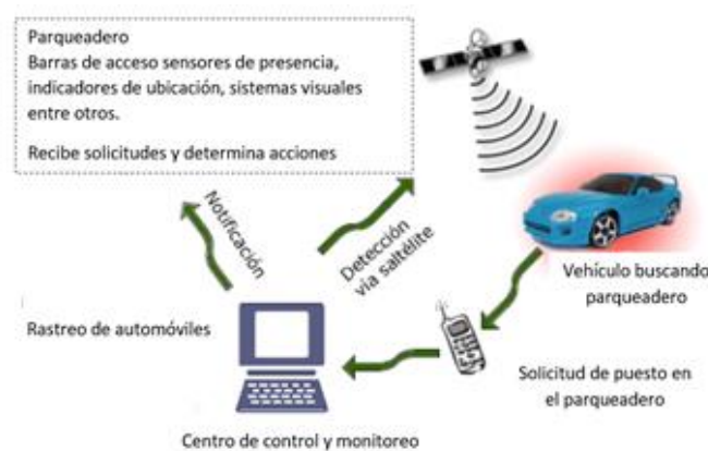
Figura 6 Diagrama funcional del parqueadero basado en GPS.
