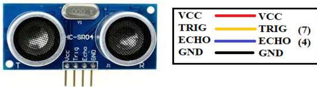
Figura 18. Distribución de pines del sensor ultrasónico HC-SR04 Fuente: Adaptado de: (Proserquisa de C.V Equipo de laboratorio Didáctico, 2016)
