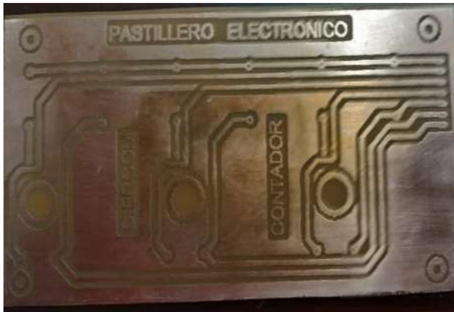
Figura 36. Proceso de quemado de la parte inferior del circuito contador. Fuente: Elaborado por el Autor.
