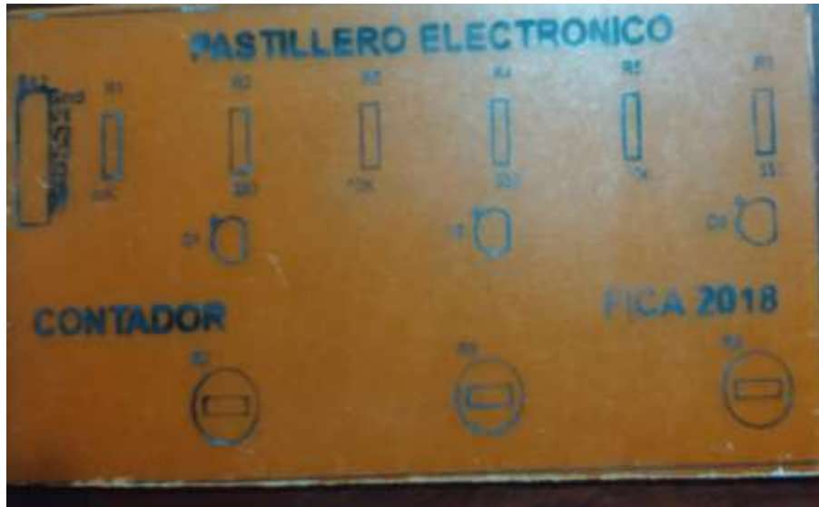
Figura 35. Proceso de quemado de la parte superior de placa del circuito contador Fuente: Elaborado por el Autor.
