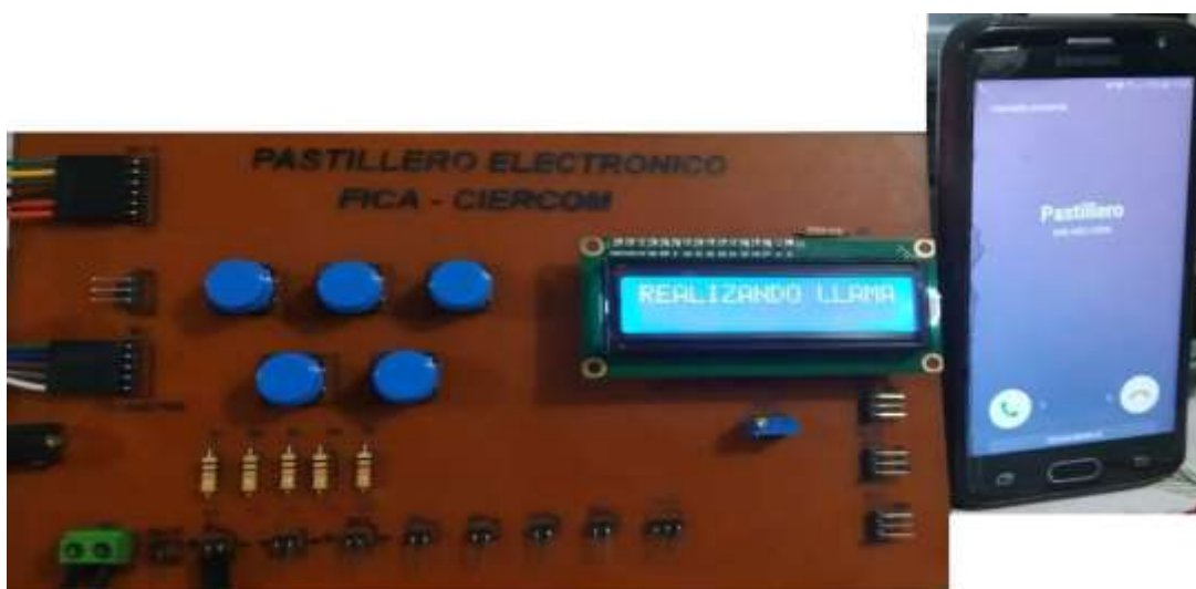
Figura 64. Prueba de funcionamiento de la notificación de la llamada de voz. Fuente: Elaborado por el Autor. }
