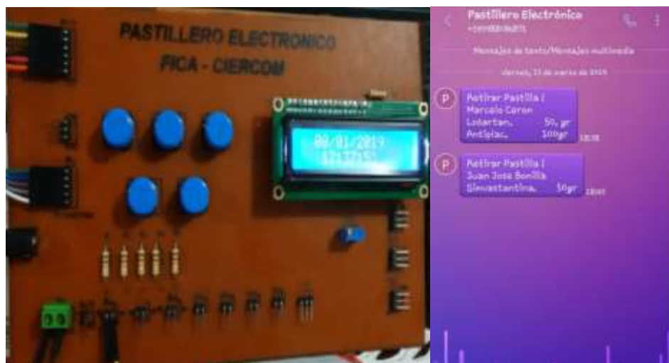
Figura 62. Prueba de funcionamiento del envío de mensaje de texto desde el módulo GSM/GPRS a un teléfono móvil. Fuente: Elaborado por el Autor.
