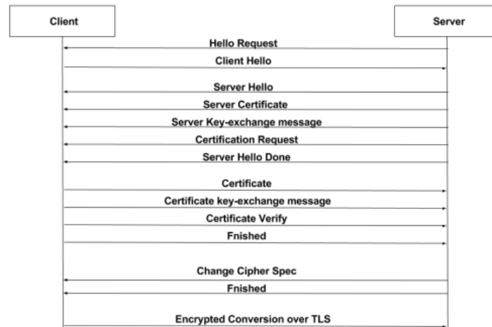
Figura 10: EAP TLS Handshake Recuperado: (Baheti, 2015)
