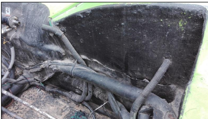
Figura 2.11 Oxidación partes laterales de vehículo tipo anfibio
