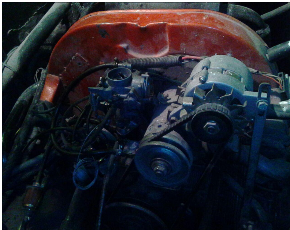
FIGURA AI.3. Motor sin funcionamiento debido al ingreso de agua en los cilindros
