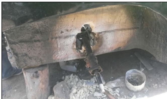
Figura 2.10 Agujeros en partes laterales de caja de cambios para desmontaje
