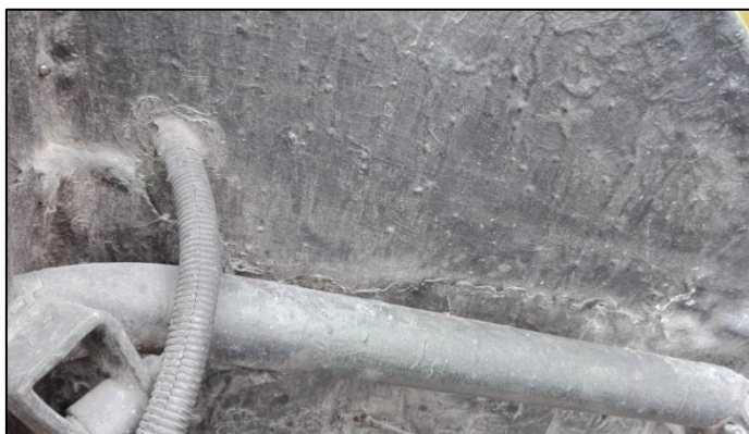
Figura 2.9 Deterioro de la fibra de vidrio en vehículo tipo anfibio
