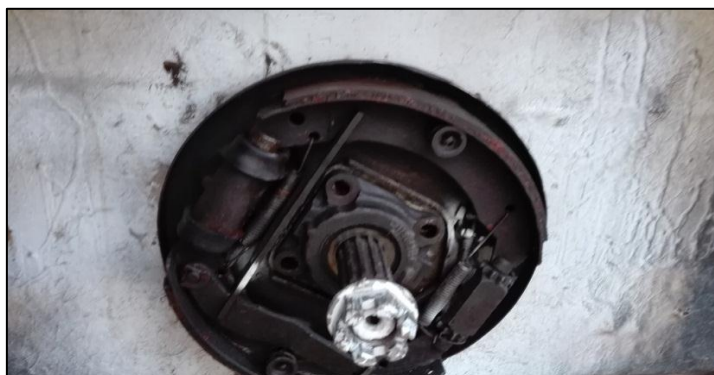
Figura 3.21 Cauchos de los cilindros de las zapatas en mal estado
