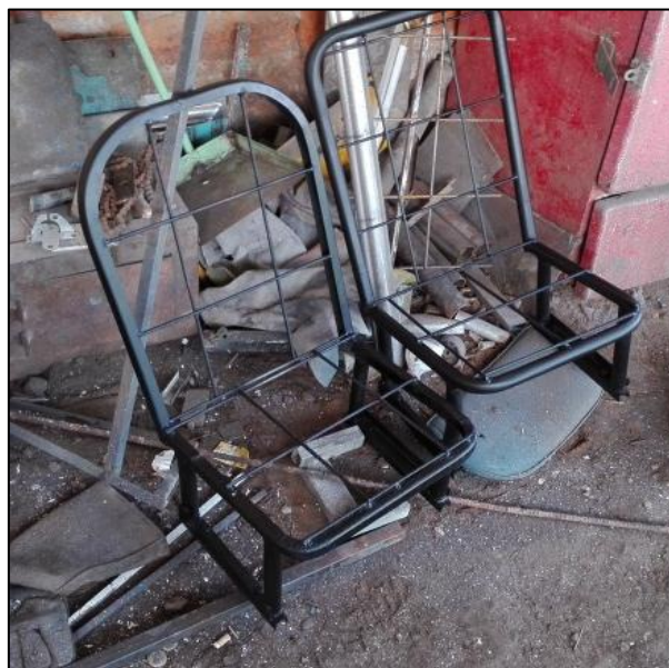
Figura 3.18 Construcción de nuevos asientos, vehículo tipo anfibio
