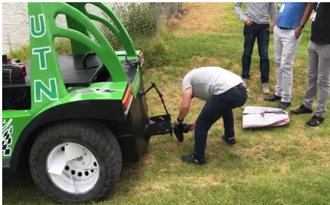
FIGURA AIV.3. Colocación de la hélice antes del ingreso a la laguna, para el direccionamiento del vehículo en el agua
