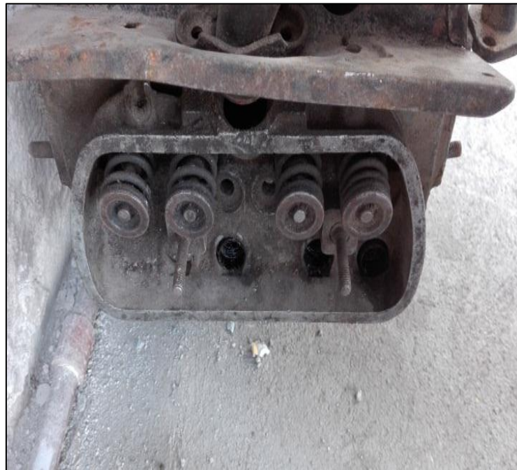
Figura 2.5 Válvulas en mal estado
