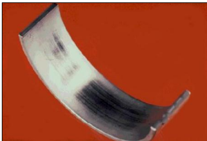
Figura 2.6 Desgaste de la capa de estaño de un cojinete (Jorge León Arista Bernal, 2014, p.3)
