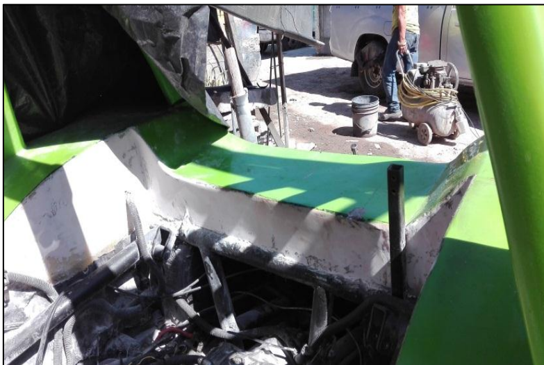
Figura 3.25 Reparación externa de fibra de vidrio en vehículo tipo anfibio
