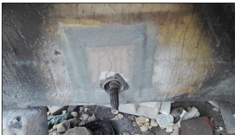
Figura 3.22 Proceso de sellado de tambores de frenos y rodamiento desgastado
