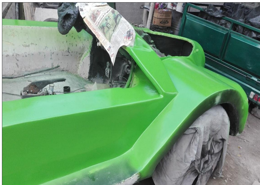
FIGURA AII.8. Proceso de pintura, parte externa del vehículo
