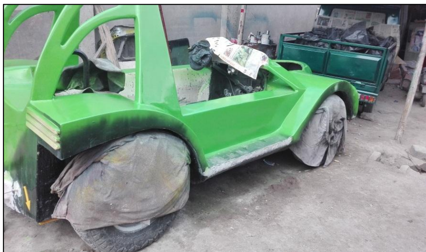
Figura 3.32 Corrección y finalización del proceso de pintura
