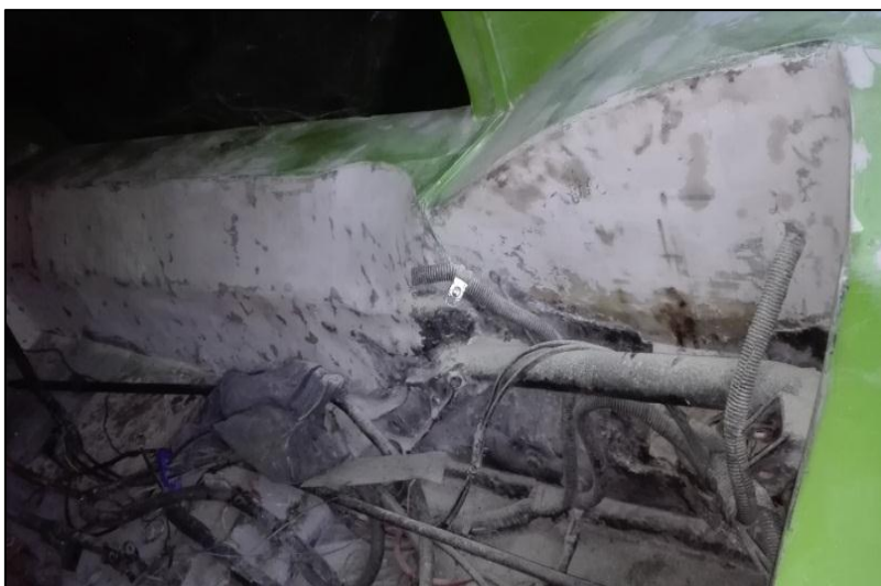
Figura 3.27 Reparación de la base del vehículo tipo anfibio
