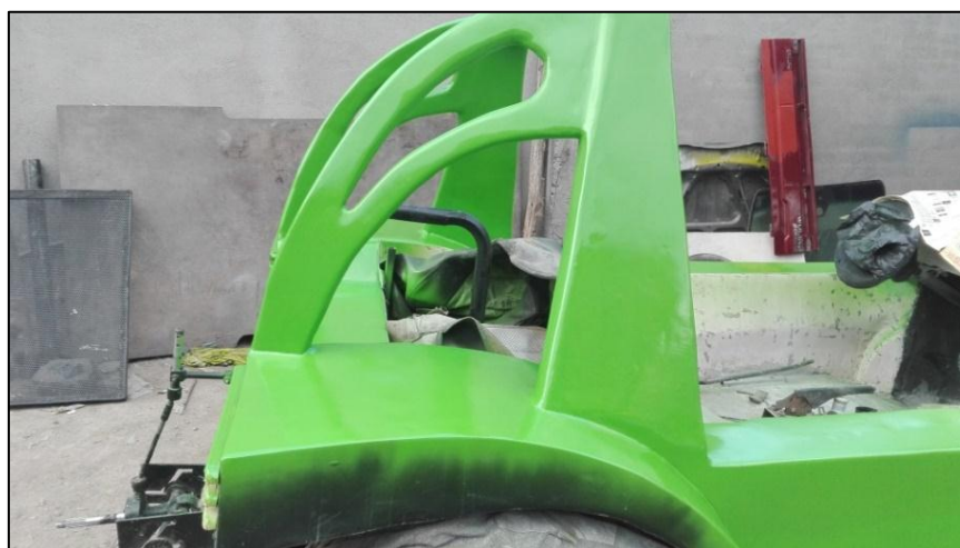
Figura 3.33 Finalización de proceso de pintura
