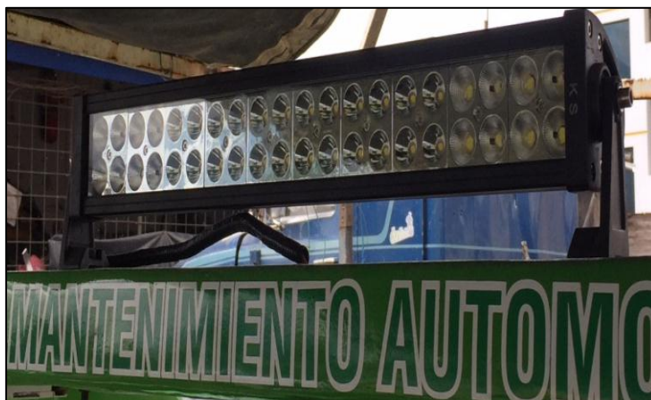
Figura 3.12 Instalación barra de luces tipo led en vehículo tipo anfibio
