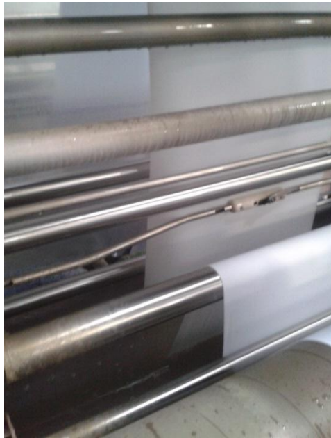
Figura N° 24 Cuba de Impregnación del Acabado
