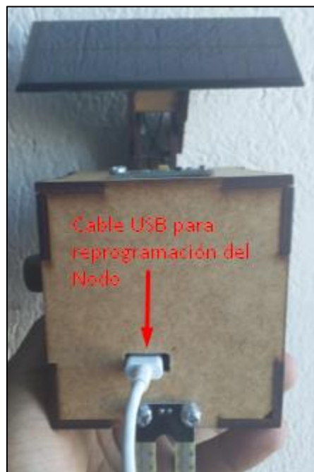
Ilustración 28. Conexión del cable USB para reprogramación del Nodo
