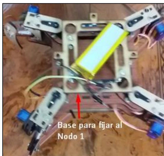
Ilustración 35. Sujeción de la base que sostiene al Nodo 1
