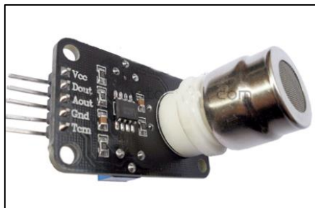
Figura 34. Estructura y distribución de pines del sensor MG 811.
