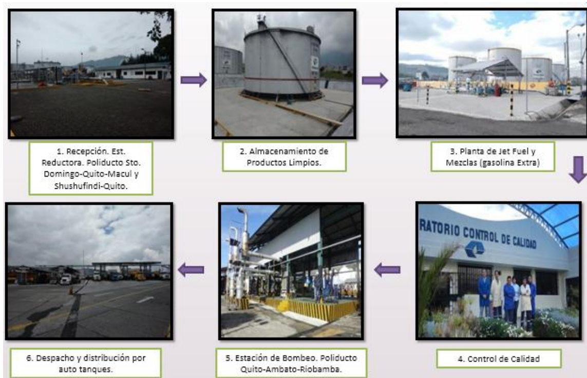
Ilustración 10. Diagrama de Procesos EP PETROECUADOR Fuente: EP PETROECUADOR Elaborado por: Mishell Cerpa
