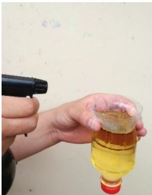
Figura 2.10 Lavado del biodiésel a base de piñón
