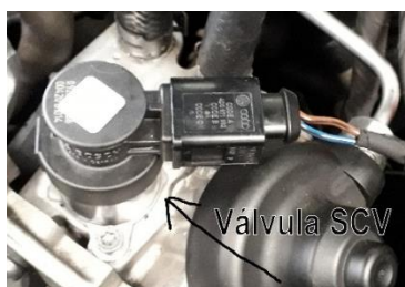
Figura 2.14 Ubicación de la válvula SCB en el vehículo Volkswagen Amarok
