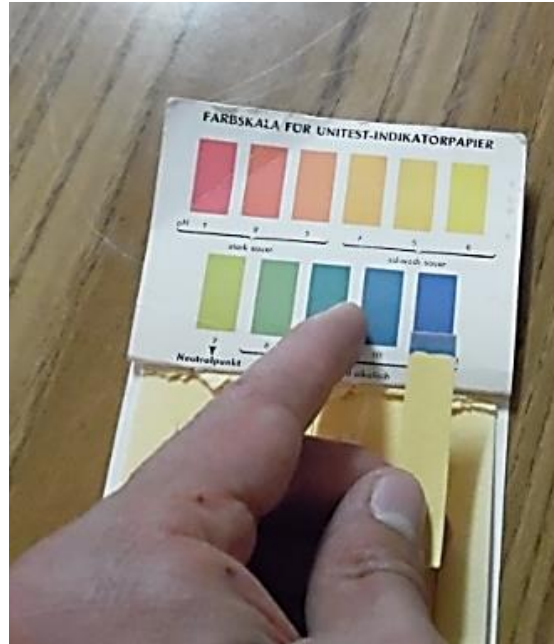
Figura 2.7 Medición de PH al metóxido
