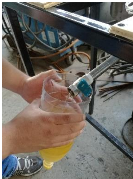
Figura 2.8 Finalización del proceso de esterificación en el reactor
