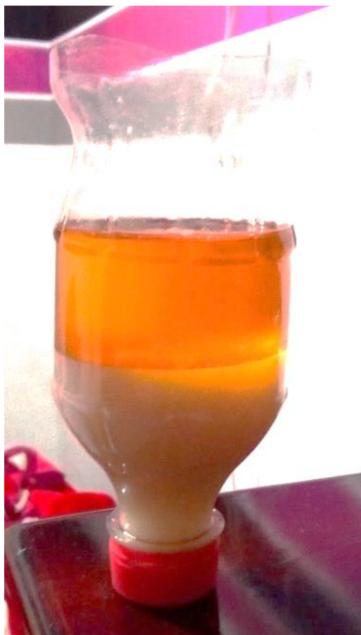
Figura 2.9 Biodiésel reposado en el que se observa dos fases
