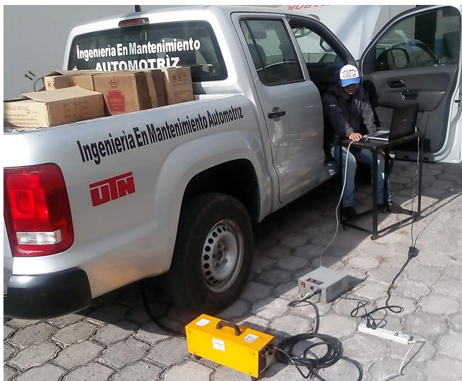
Figura 2.2 Opacímetro Brain Bee OPA-100 conectado y listo para realizar mediciones de opacidad al vehículo Amarok
