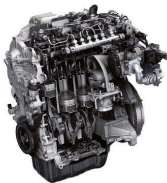
Figura 1.1 Motor combustión interna. (Sanz S. , 2017, pág. 2)
