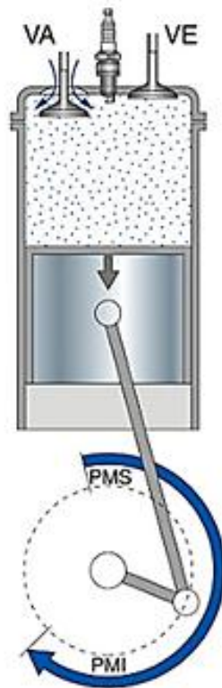
Figura 1.17 Avance apertura admisión, Retraso apertura admisión.
