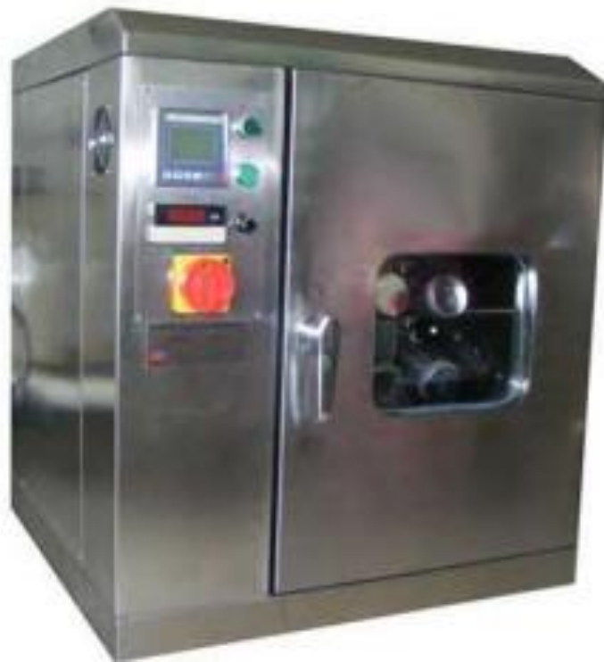
Figura 5. Autoclave de laboratorio, ModeloRHS-24
