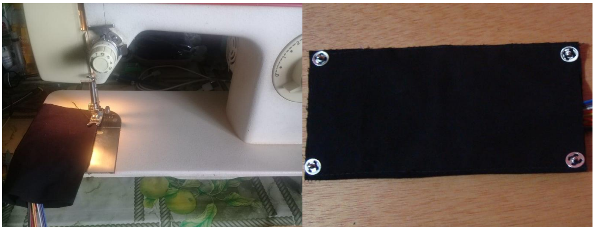
Anexo 4. Costura de bordes de tela tarjeta Arduino LilyPad Fuente: Ulcuango Rubí
