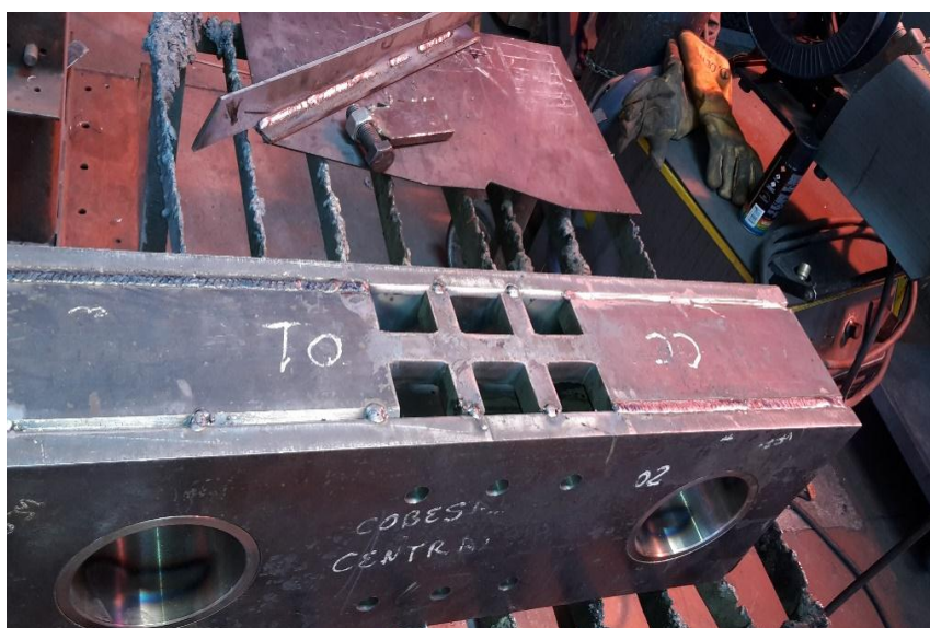
Figura 57. Proceso de soldadura - Cabezal Central
