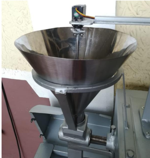
Figura 3. 26 Tolva en la estructura.
