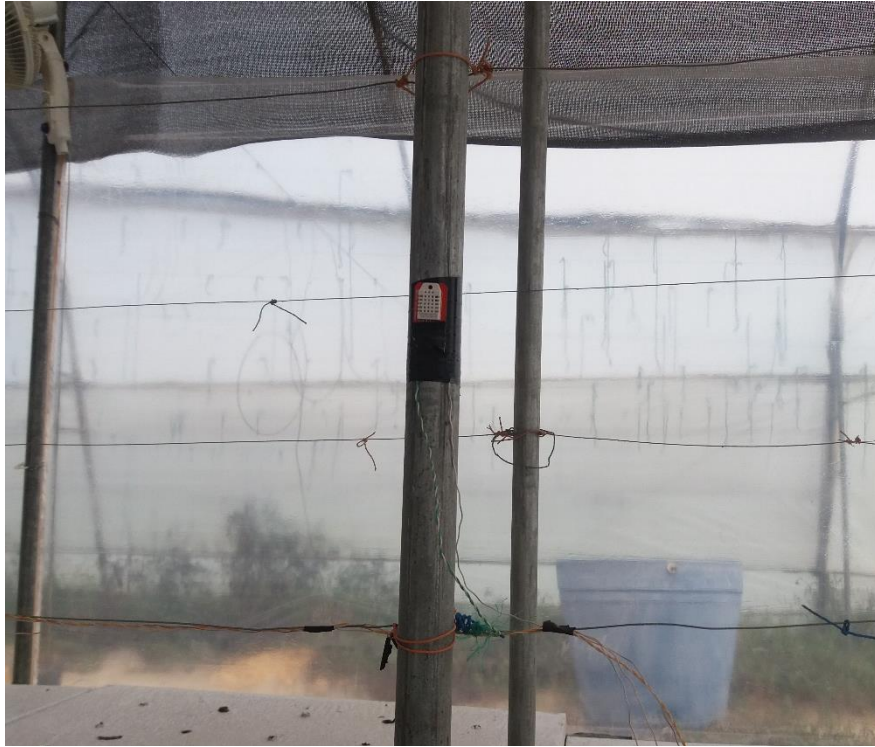
Figura 7. Sensores instalados en pilares del recinto
