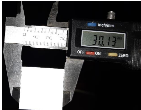
Figura 0.5 Corte final de una pieza sencilla “error de 4.33%”
