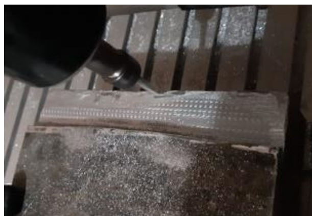
Figura 0.3 Desbaste de material.
