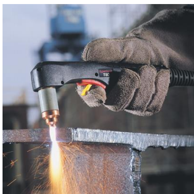
Figura 0.5 Corte con plasma (Deformación del material) [18].
