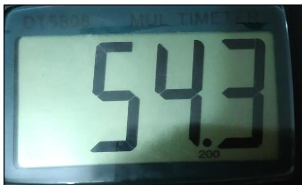
Figura 4.56. Voltaje de las baterías medidas con un multímetro digital.
