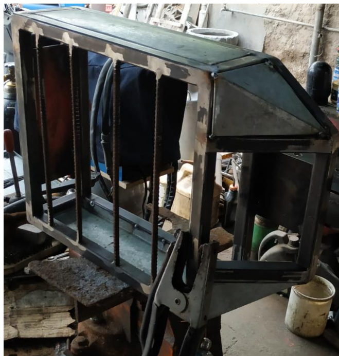
Figura 4.17. Construcción del chasis, soldado de láminas.
