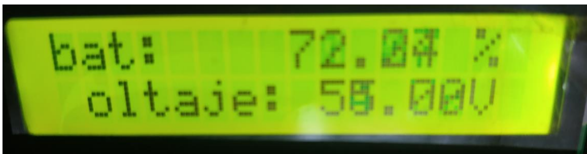
Figura 4.57. Voltaje de las baterías medidas con el sensor de voltaje diseñado.
