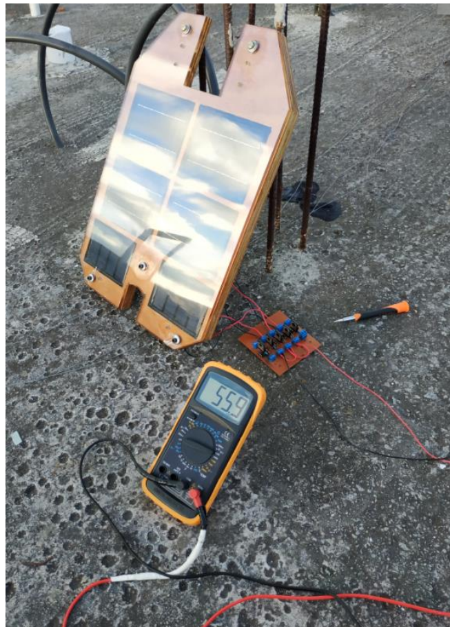
Figura 4.54. Pruebas de voltaje nominal suministrado por el panel fotovoltaico, luego de pasar por la placa reguladora de voltaje.
