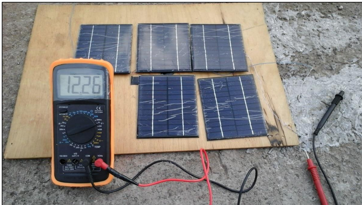
Figura 0.1. Pruebas de tensión de cada célula fotovoltaica. Fuente: Elaboración Propia.
