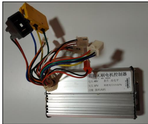
Figura 4.20. Controlador para el motor seleccionado, 48 V a 1500 W.
