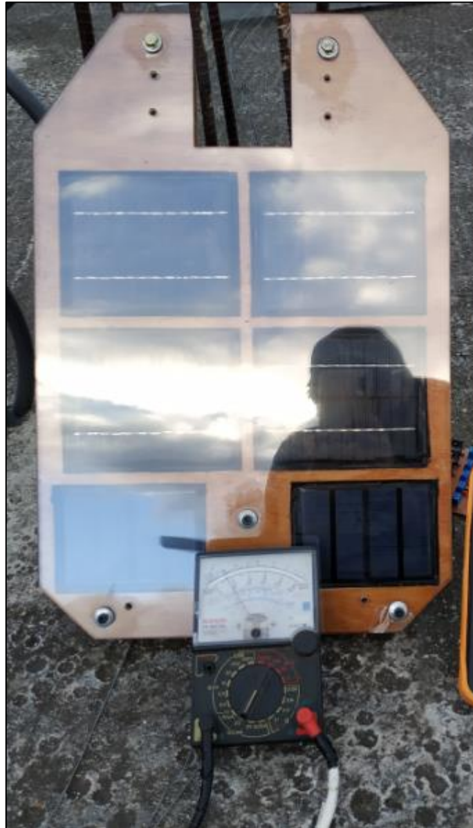
Figura 4.55. Pruebas de corriente nominal, suministrado por el panel fotovoltaico, luego de pasar por la placa reguladora de voltaje.
