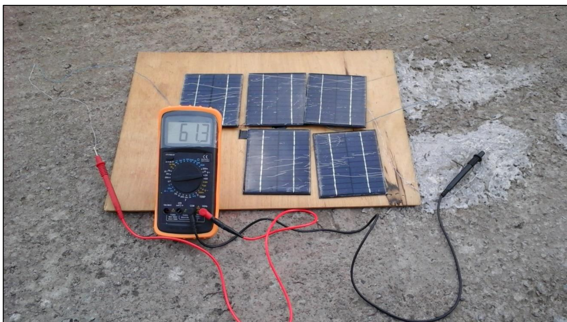
Figura 0.2. Pruebas de tensión de las células fotovoltaicas asociadas. Fuente: Elaboración Propia.
