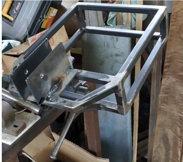
Figura 4.16. Construcción del chasis, soldado de estructura.
