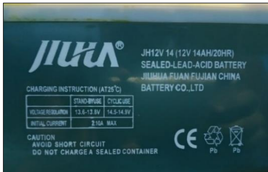
Figura 4.24. Batería de plomo ácido sellado, marca Jihua de 12 V a 14 Ah.
