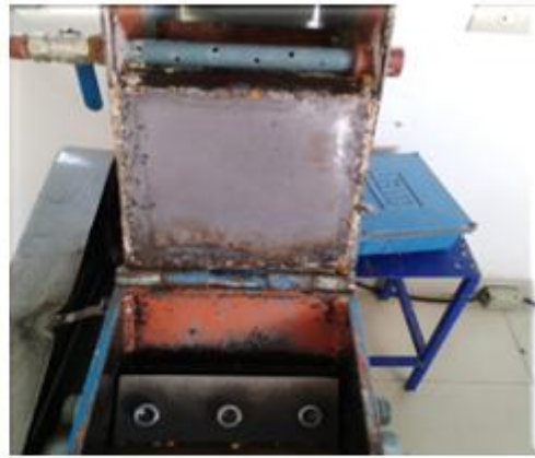
Después: paso de agua y recubrimiento interno de la tolva reparados.
