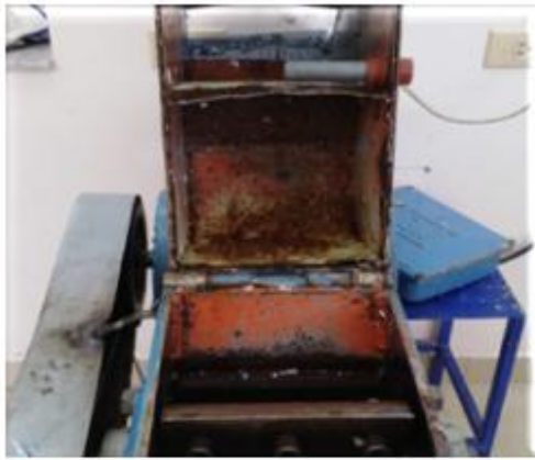
Antes: Paso de agua y recubrimiento interno de la tolva dañados.
