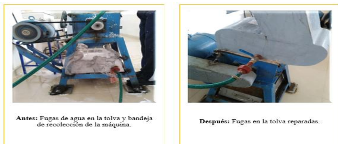
Fotografía N° 2.- Mantenimiento de la máquina trituradora
