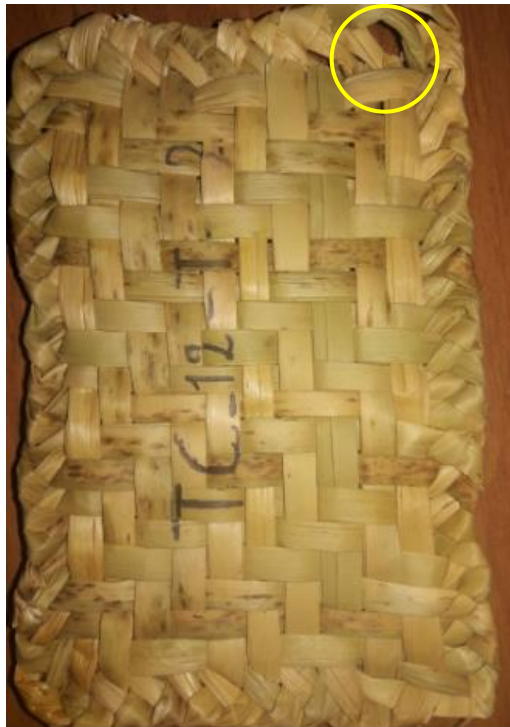
Figura 3.21. Fracturas en probeta TC_12
