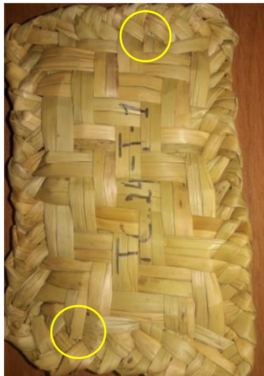
Figura 3.22. Fracturas en probeta TC_24
