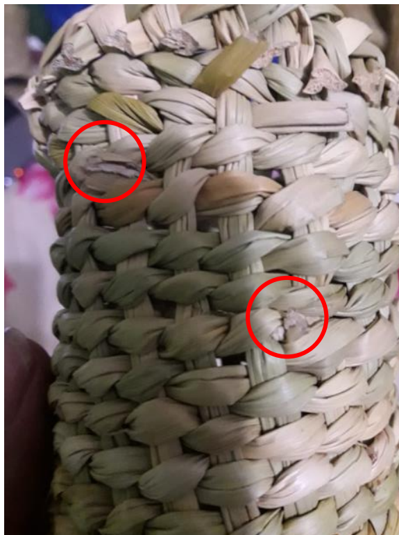
Figura 3.24. Fracturas en probeta TE
