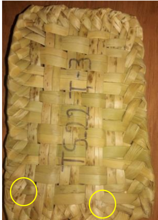
Figura 3.23. Fracturas en probeta TS_22
