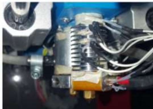
Figura 78: Distribución de Termistores a lo Largo del Extrusor de Aire
