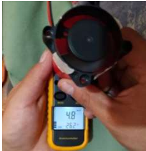
Figura 45: Toma de Valores Experimentales de Ventilador Grande con Porcentaje de PWM al 100 % Utilizando un Anemómetro
