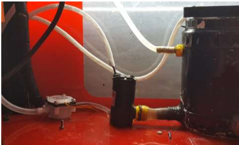
Figura 52: Sistema de Enfriamiento del Extrusor de Agua (Reservorio, Bomba, Sensor y Purga)
