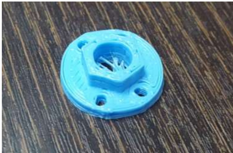
Figura 107: Impresión Realizada con el Extrusor de Agua
