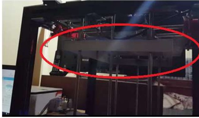
Figura 26: Bases Inestables y Desgastadas de Impresora Proporcionada Inicialmente
