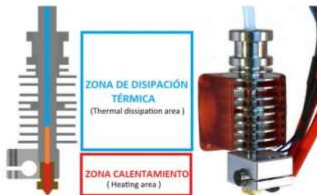
Figura 2: Partes constitutivas del extrusor enfriador por aire Fuente: [8]
