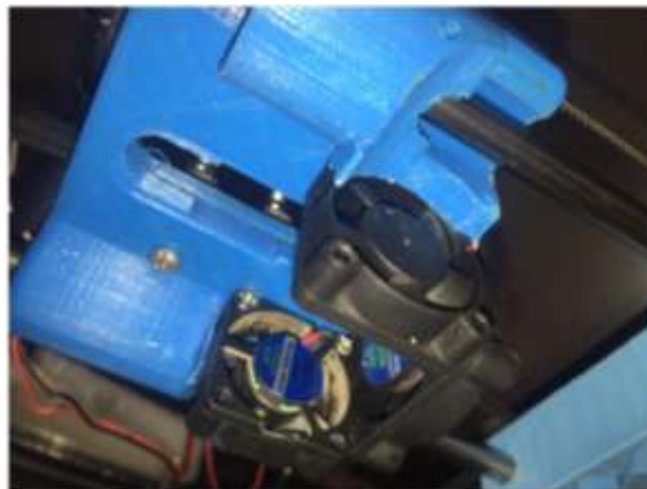
Figura 42: Ventiladores Acoplados a la Base Soporte de Extrusores
