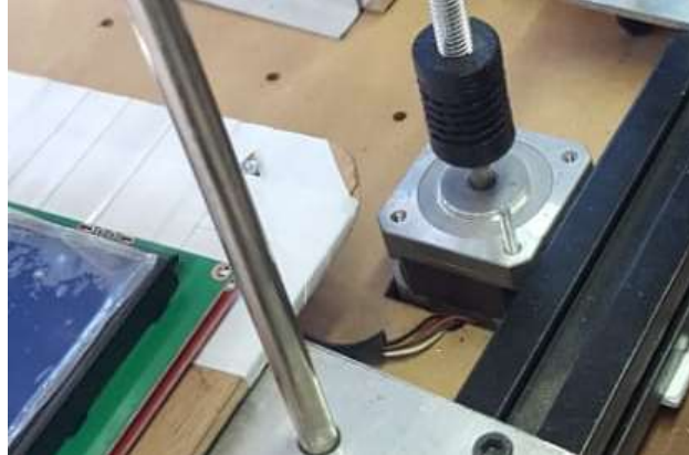
Figura 28: Motor Nema Expuesto sin Protección de Impresora Proporcionada Inicialmente
