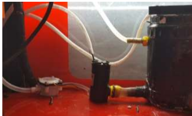
Figura 99: Sistema de Flujo de Agua (bomba, sensor y reservorio)
