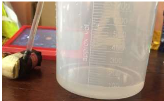
Figura 103: Toma de Datos de Flujo de Agua con la bomba desconectada del sistema al 100% de su pwm
