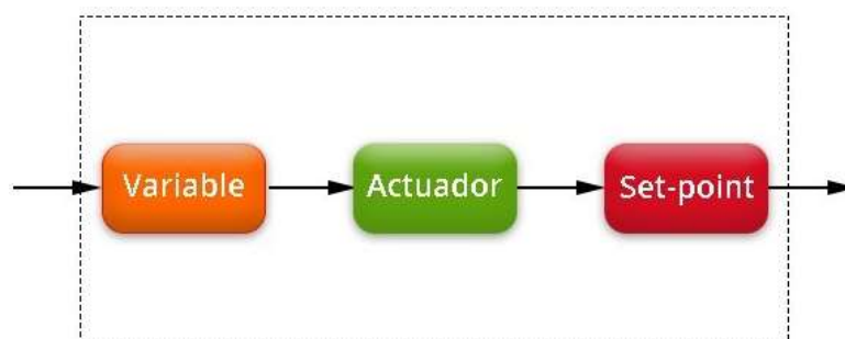
Figura 17: Sistema de Control en Lazo Abierto Fuente: [32]
