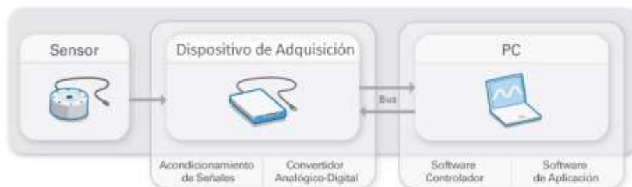
Figura 13: Proceso de Adquisición de Datos Fuente: [27]
