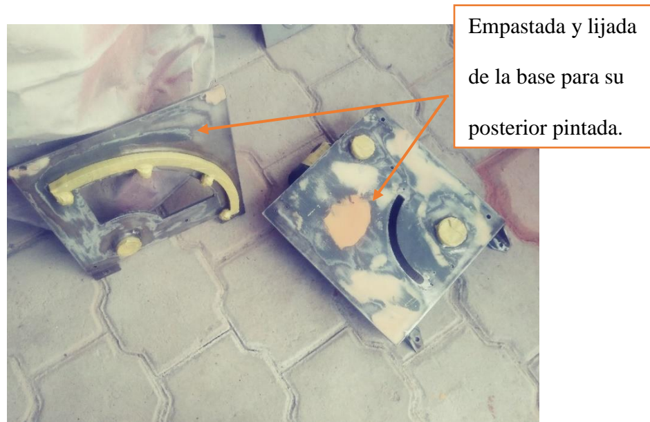
Figura 24. Mantenimiento de la plancha de acero
