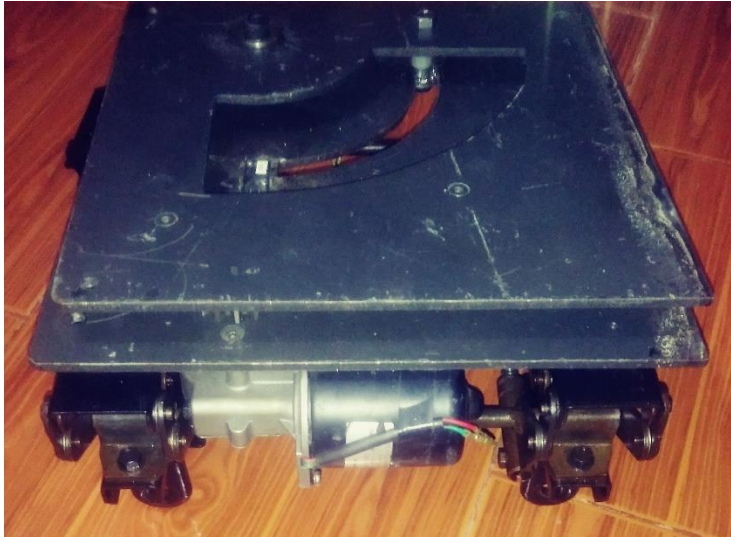
Figura 22. Sistema de giro modificado acoplado a la base de asiento comercial.
