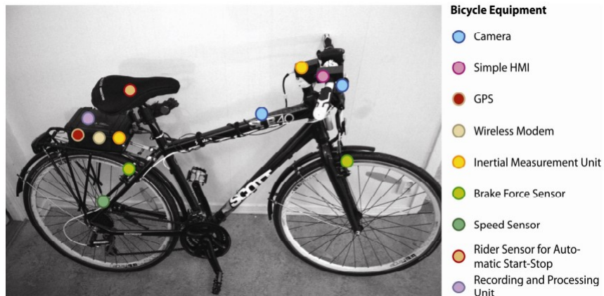
Figura 2.2: Bicicleta instrumentada utilizada en [18]
