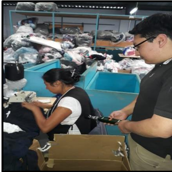
Figura 30: Medidor de Estrés Térmico HT30 Fuente: Respaldo fotográfico Elaborado por: Álvaro Arellano.
