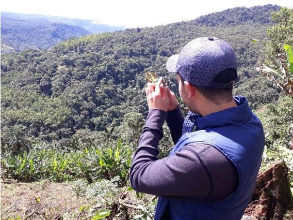
**Fotografía 11.** Obtención del azimut sur para la realización de la cuenca visual.
