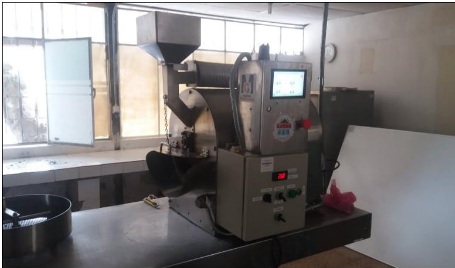
Figura 68: Montaje del módulo en la máquina tostadora de café
