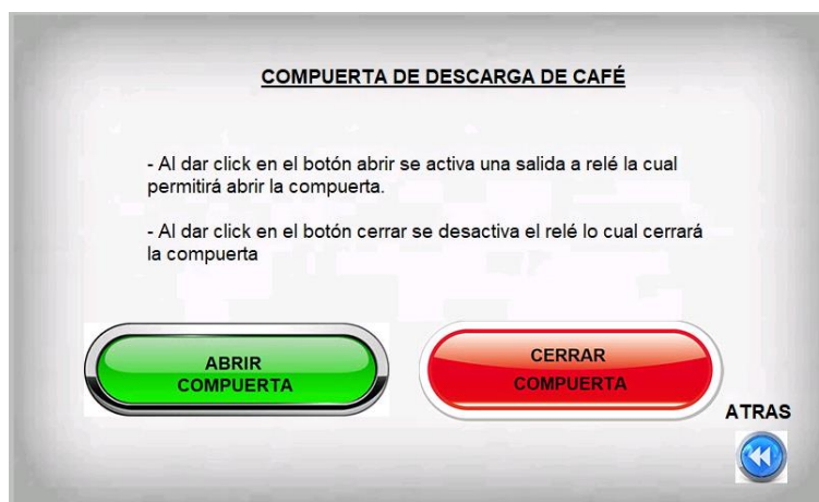
Figura 65: Compuerta de descarga de café
