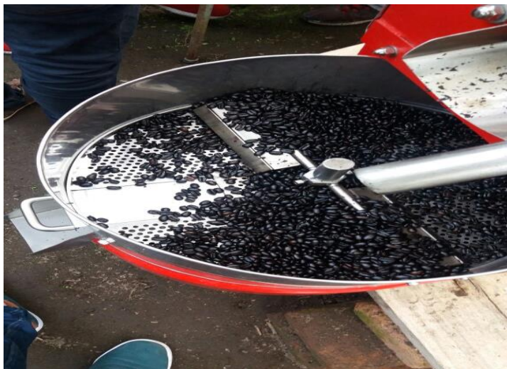
Ilustración 2: Sistema de enfriamiento
