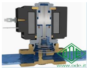
Figura 23: Electroválvula normalmente abierta de acción directa. Fuente: [14]
