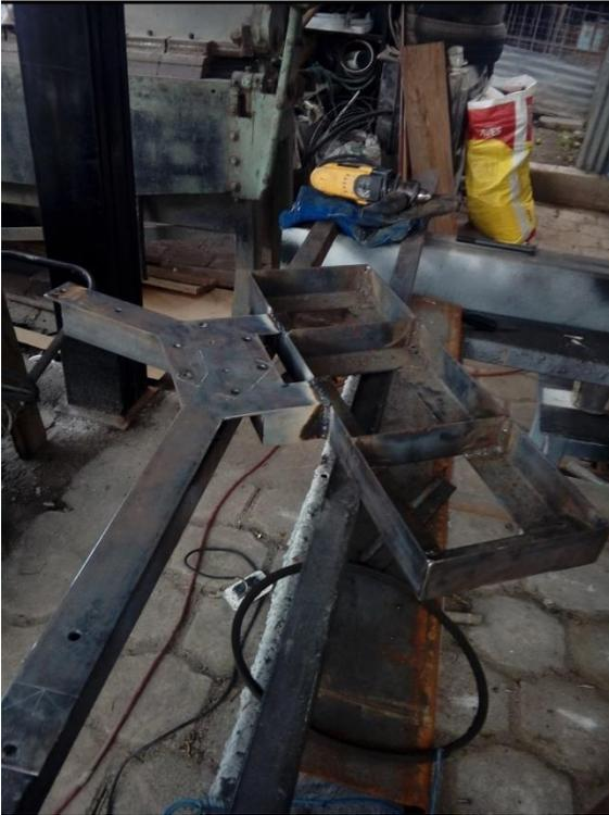
*Ensamblado base central con laterales*
