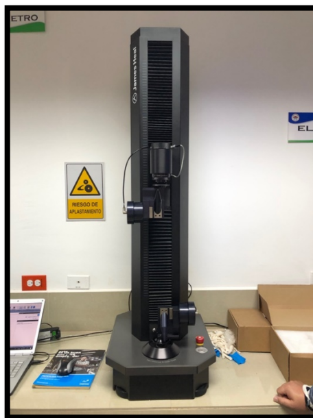
Figura 24. Dinamómetro Titan 5 Universal Strength Tester.
