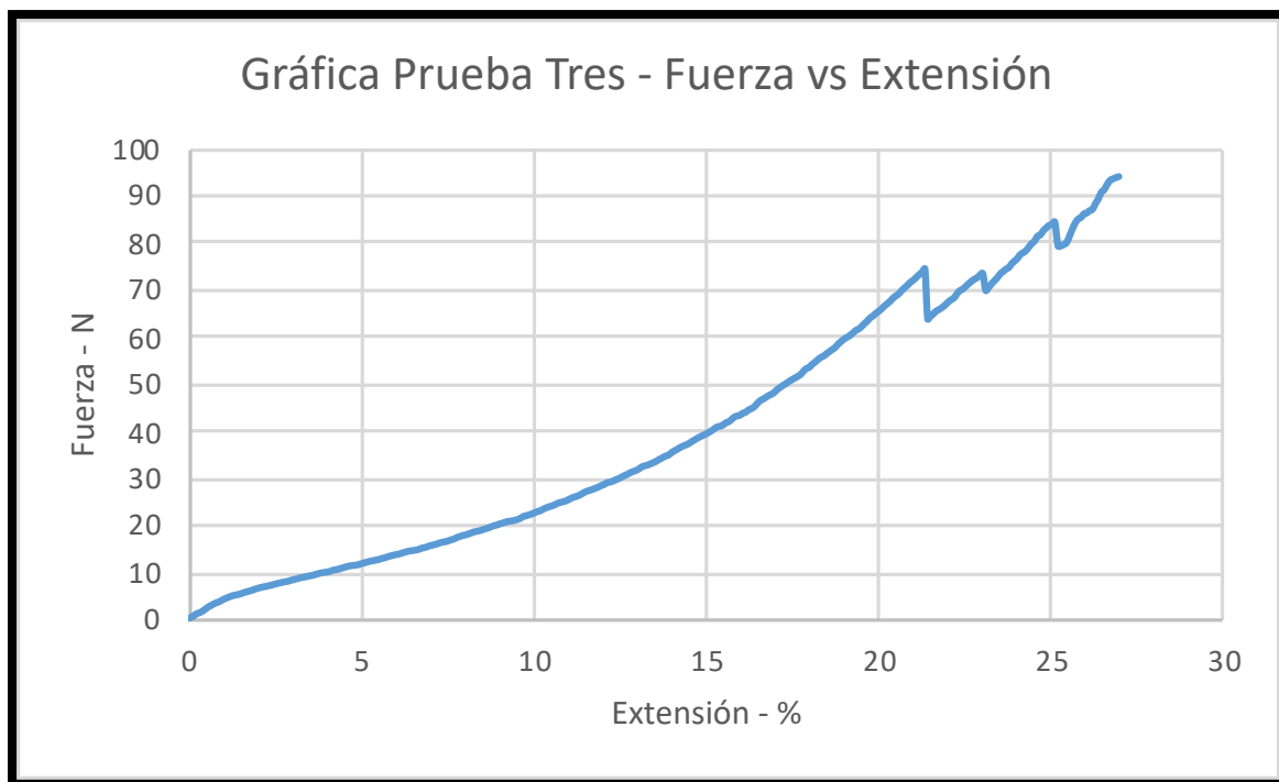
Figura 29. Curva característica de Fuerza vs Extensión, Natural
