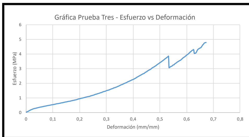
Figura 43. Curva característica de Esfuerzo vs Deformación, Natural.
