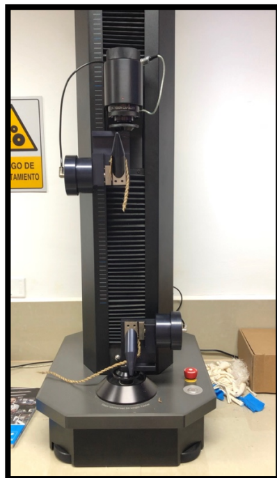
Figura 63. Probeta fracturada después del ensayo experimental a tracción
