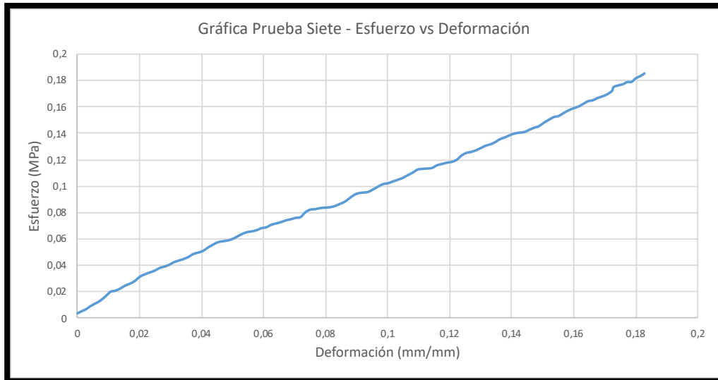
Figura 52. Curva característica de Esfuerzo vs Deformación, Idealizada.
