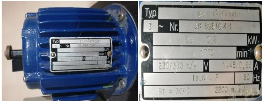
Figuras 49. MOTOR 2 Placa característica
