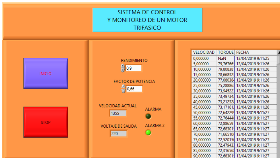
Figuras 56. Valores en tabla Prueba de par de régimen MOTOR 1, rendimiento y factor de potencia
