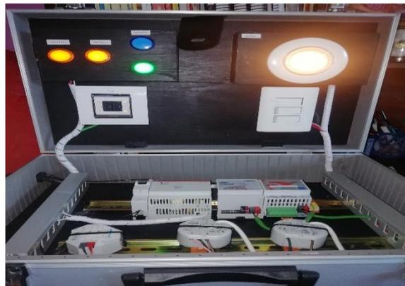
**Figura 32:** Diseño de vista interior del módulo para prácticas base de control.
