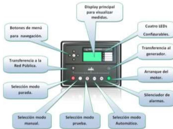
Fig.32. Módulo de control DSE 7320
