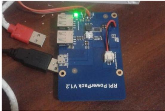
*Figura 90. Módulo RPI Powerpack en modo encendido.*
