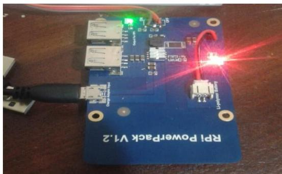
*Figura 91. Módulo RPI Powerpack en modo de carga.*
