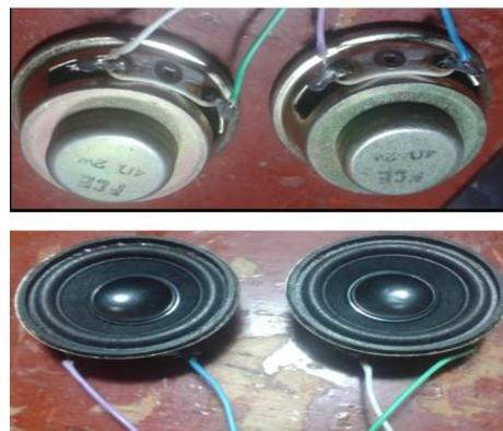
Figura 43. Soldadura de cables para altavoces.
