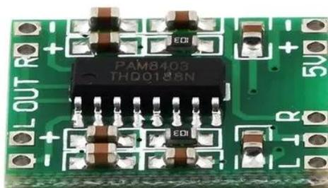
Figura 128. Módulo amplificador de audio PAM8403.
