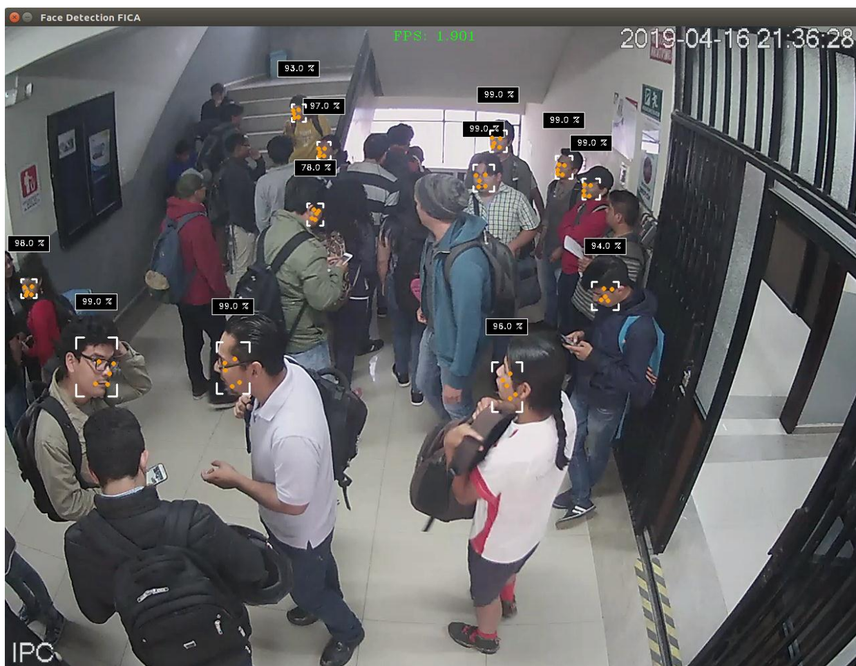
Figura 85. Detección facial pasillo primer piso FICA.
