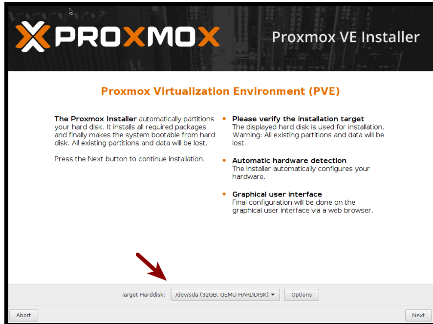
Figura F- 5. Pantalla de selección de la media de destino para instalación. Fuente: Propia Autor, (2019).
