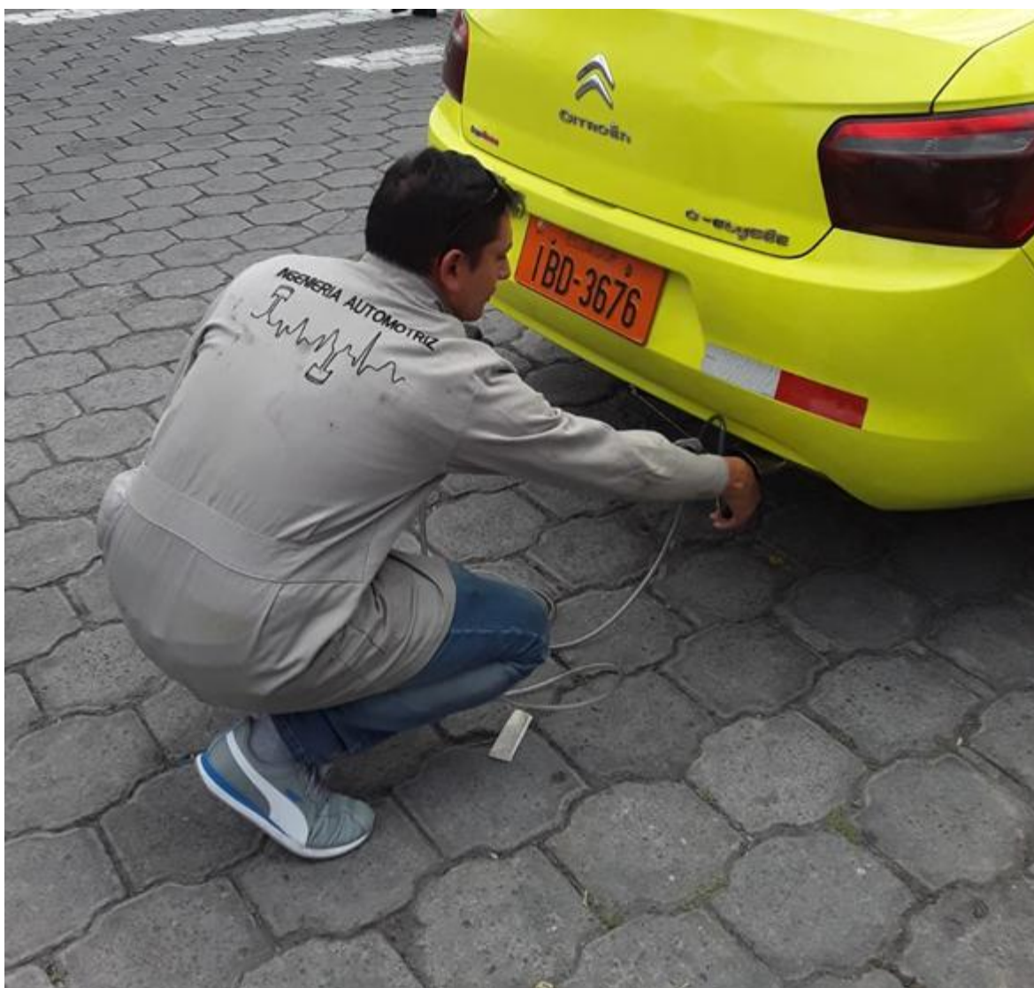
Figura AIII.3 Colocación del analizador portátil
