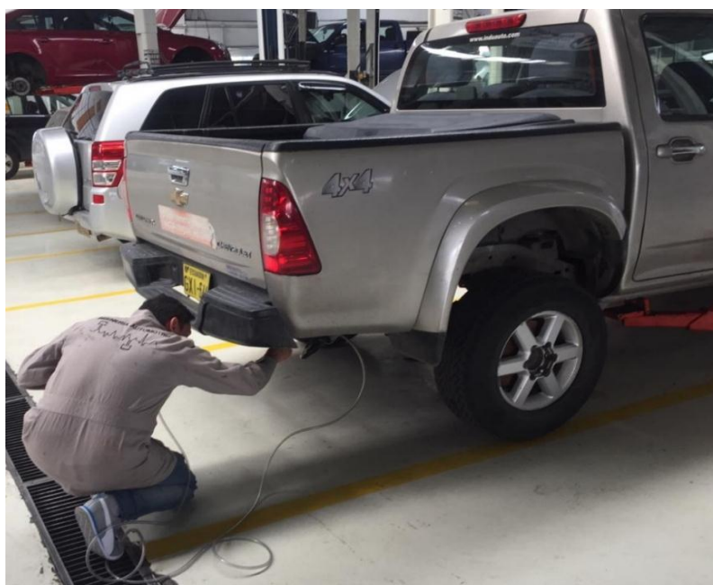
Figura 2.3 Colocación del analizador
