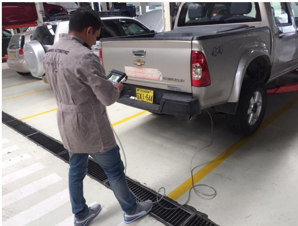
Figura 2.4 Medición de los gases NOx
