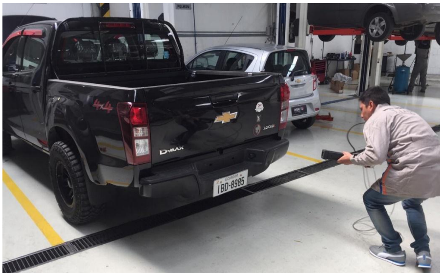
Figura 2.2 Verificación del sistema de escape
