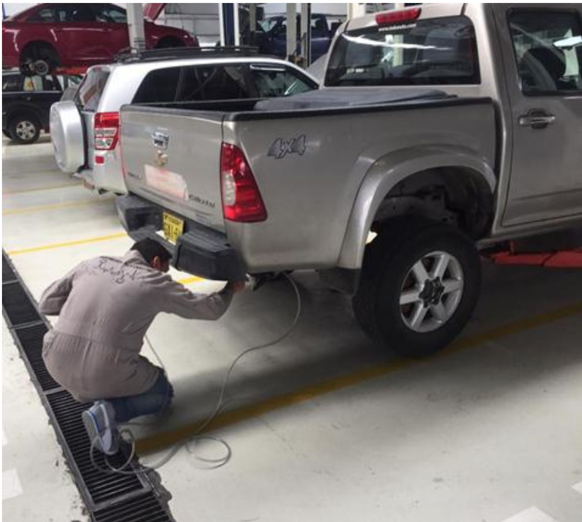
Figura AI. 1 Colocación de la sonda de medición.
