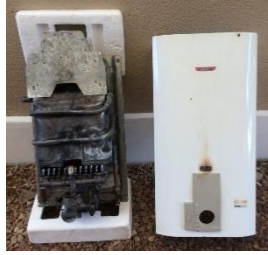
Figura 4: Calefón a gas Fuente: Autor
