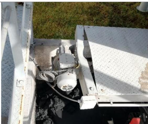
**Potencia:** 1,1 KW **Corriente:** 2,40A **Voltaje:** (220delta-380Y)V
