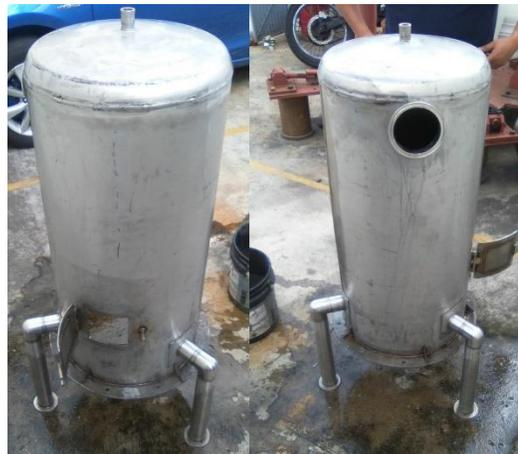
Figura 31 Tanque digestor armado
