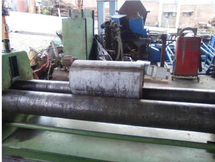
Figura 25 Dobles del cilindro
