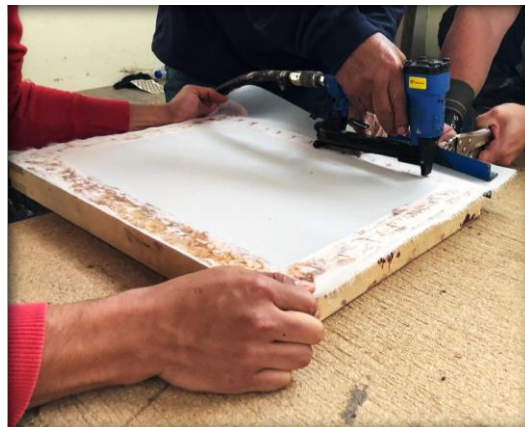
Anexos 49. Tensionado de malla para bastidor de estampado Fuente: (Guacales A, 2019)
