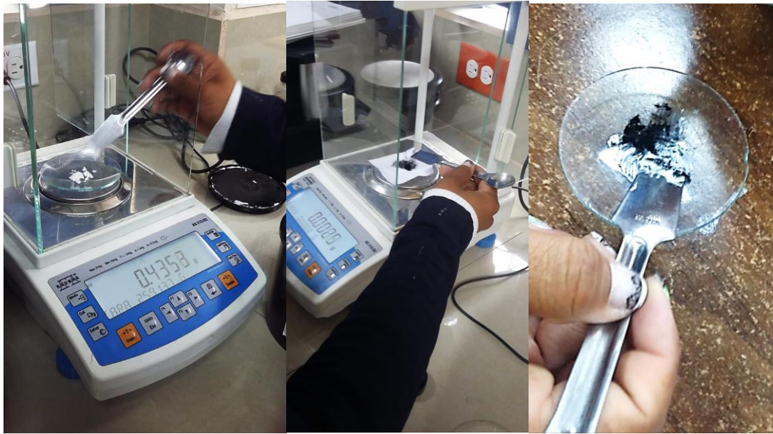
Anexos 50. Preparación de la pasta de estampado conductor Fuente: (Guacales A, 2019)
