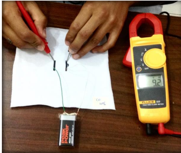
Anexos 26. Medición de voltaje de salida en CO al 10% sin lavar Fuente: (Guacales A, 2019)
