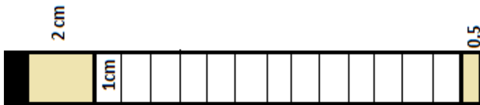
Ilustración 18 Señalización de la muestra para la prueba de absorción de humedad
