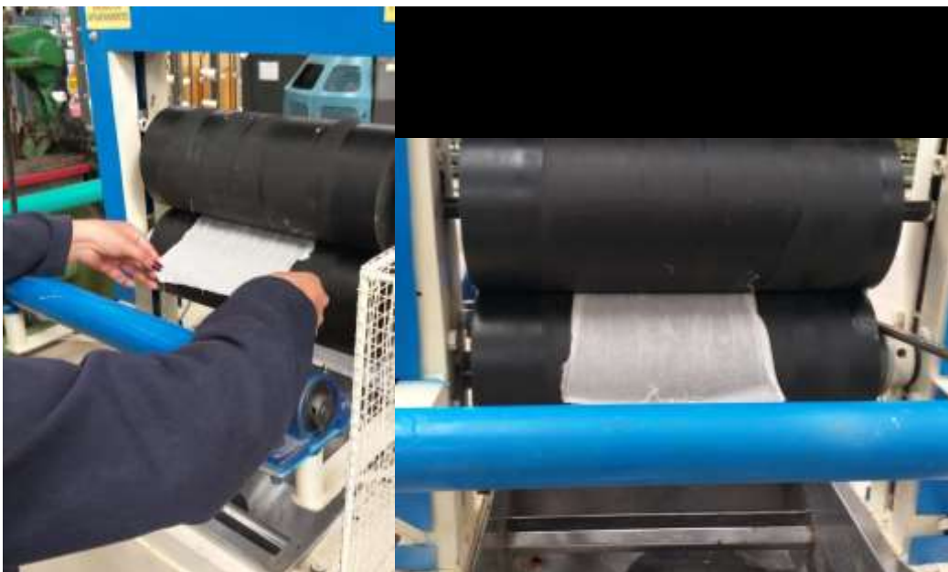
Anexo 14 Proceso de aplicación del acabado por el método de impregnación
