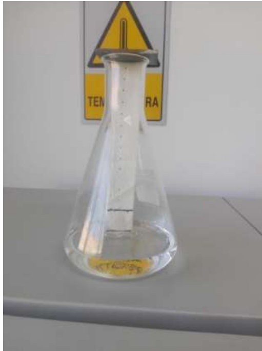
Anexo 27 Pruebas de absorción de humedad
