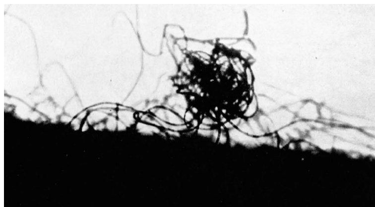
Figura 15. Se ha formado la bolita (pilling), que es mantenida al tejido por las fibras más largas que actúan como fibras de anclaje. (Mambru & Naik, 1976)
