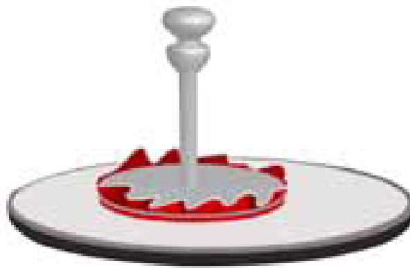
Figura 26. Principio del Pilling Test. (LABOTEX, s,f)
