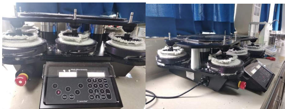
Figura 37. Equipo Martindale, laboratorio Carrera Ingeniería Textil. UTN.
