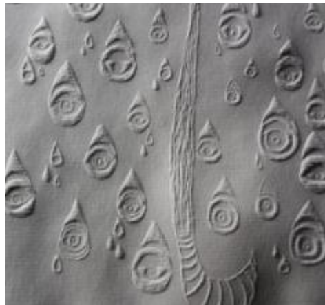
Figura 36: Efecto de gofrado sobre un tejido.
