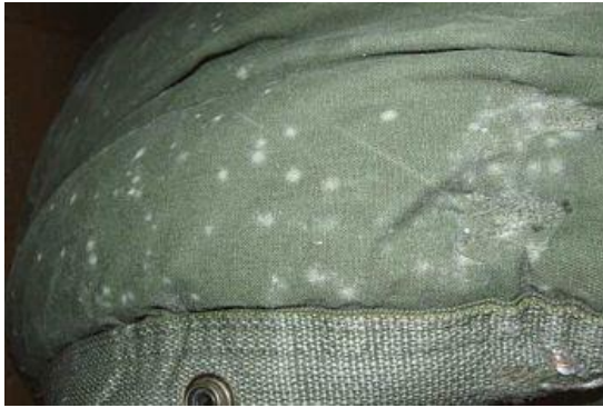
Figura 25: Manchas en la tela debido a hongos.
